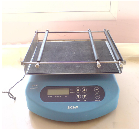
Şekil 3.6. Adsorpsiyon reaksiyonlarının gerçekleştirildiği karıştırıcı (Biosan) ve reaksiyon sonrasında katı – sıvı faz ayrımının yapıldığı santrifuj (Elektro mag)
