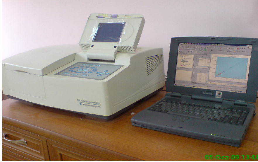
Şekil 3.7. Konsantrasyon okumalarının yapıldığı T70 UV/VIS Spektrometre cihazı.
