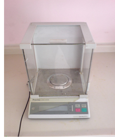
Şekil 3.5. Testlerde kullanılan adsorbantların tartımı için kullanılan hassas terazi ve sentetik atıksu numunelerinin hazırlanmasında kullanılan suyu üreten saf su cihazı
