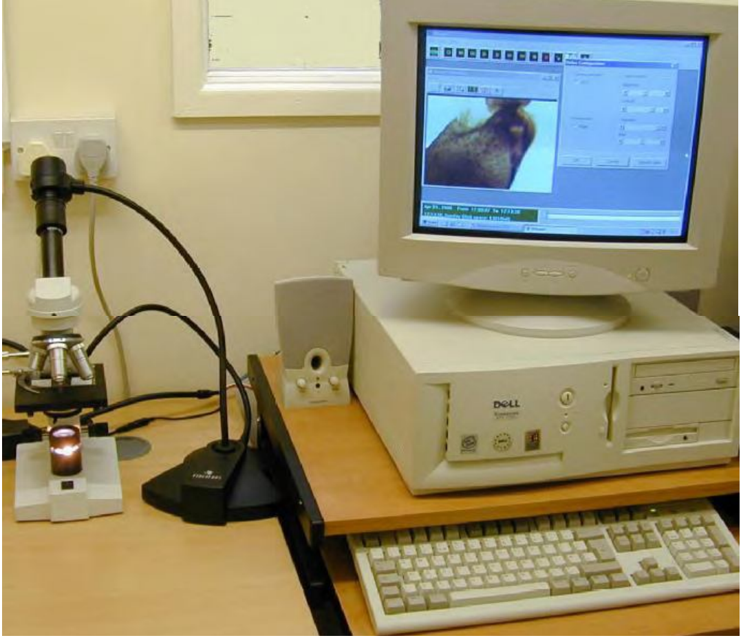
Şekil 3.8. Mikroskop altında incelenen malzemenin görüntüsünün kamerayla bilgisayara aktarımı
