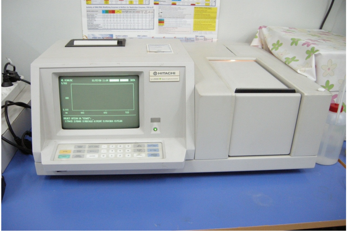
Resim 4.11. Safranal, Crocin ve Picrocrocin analizlerinde kullanılan spektrofotometre cihazı
