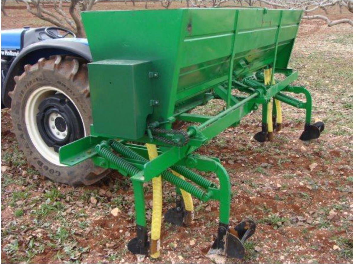
Şekil 4.1 Geliştirilmiş olan gübre dağıtma makinası
