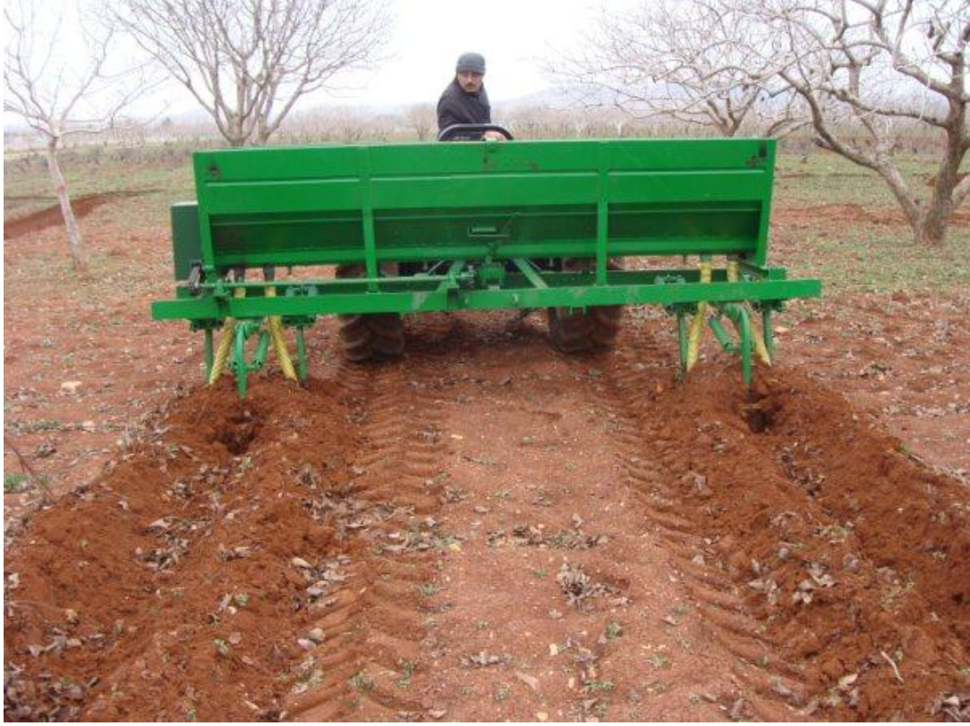
Şekil 4.3 Geliştirilen makinanın bahçede çalışma şekli
