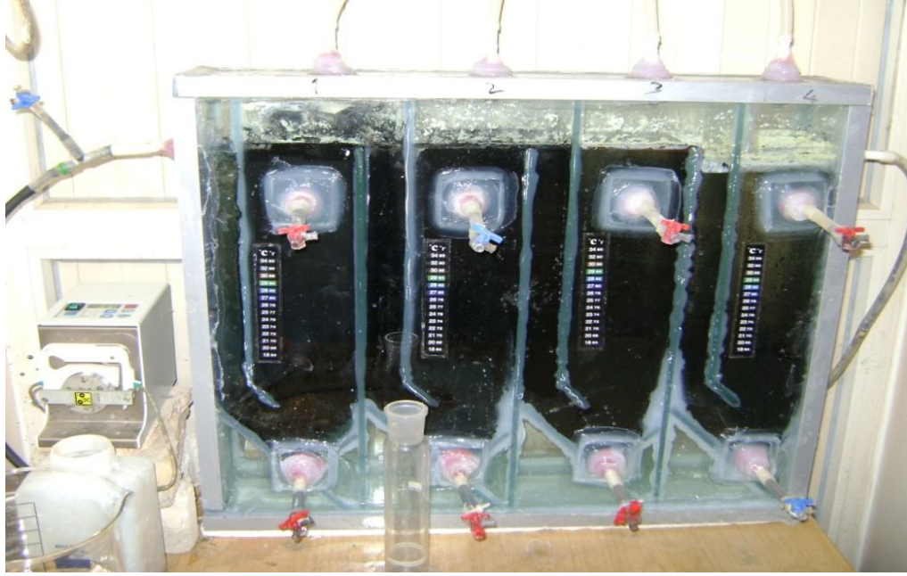
Şekil 3.2. Çalışmalarda kullanılan anaerobik perdeli reaktör
