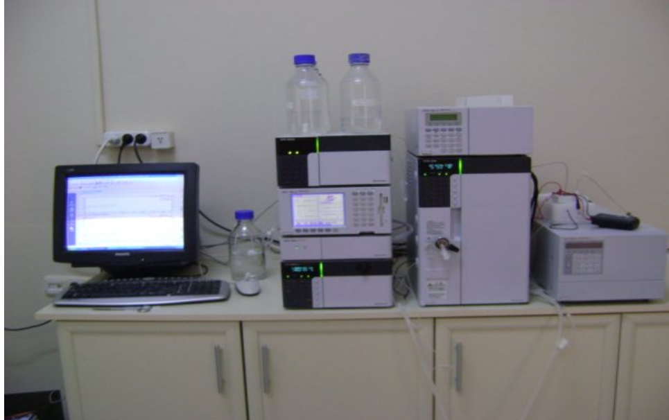
Şekil 1.3. Yüksek Performanslı Sıvı Kromatografisi (HPLC)
