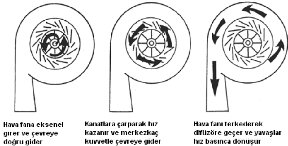
Şekil 1.2. Santrifüj kompresörde merkezkaç sıkıştırma
