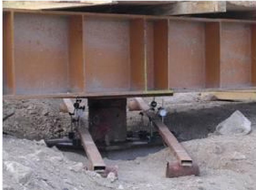
Şekil 3.21. Kazık yükleme deneyi (Düzceer, 2004)
