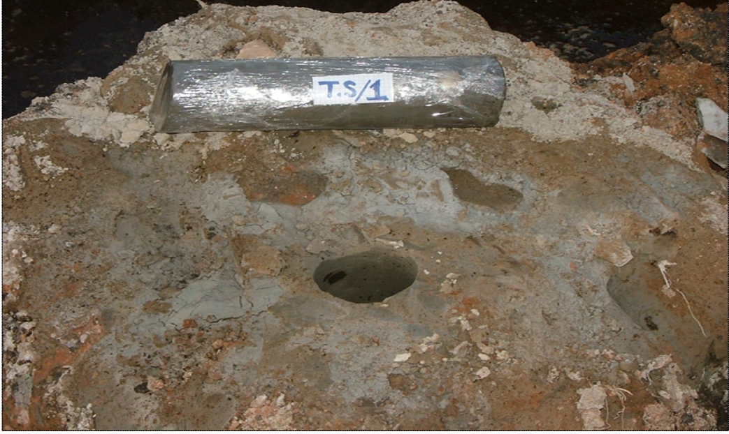
Şekil 3.20. Karot numune örneği (Yıldız, 2011)
