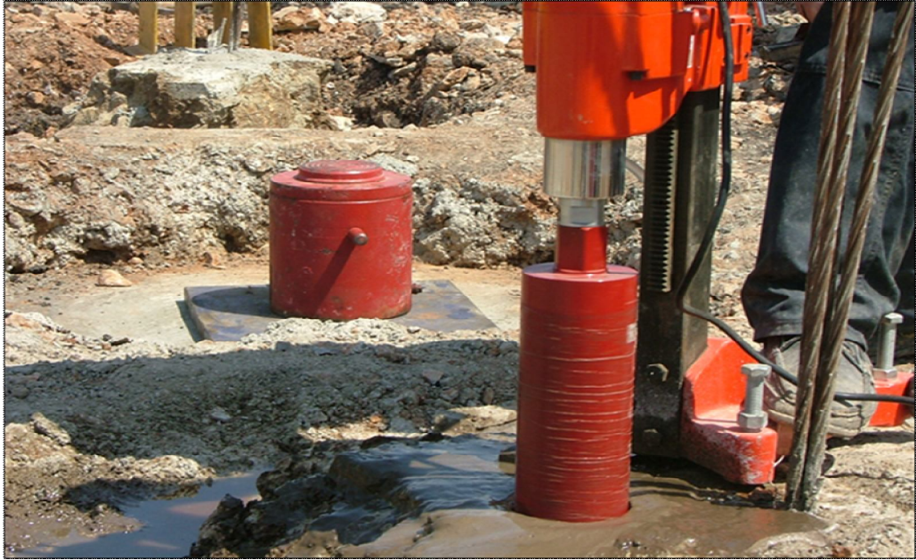
Şekil 3.19. Karot numunelerin alınması (Yıldız, 2011)
