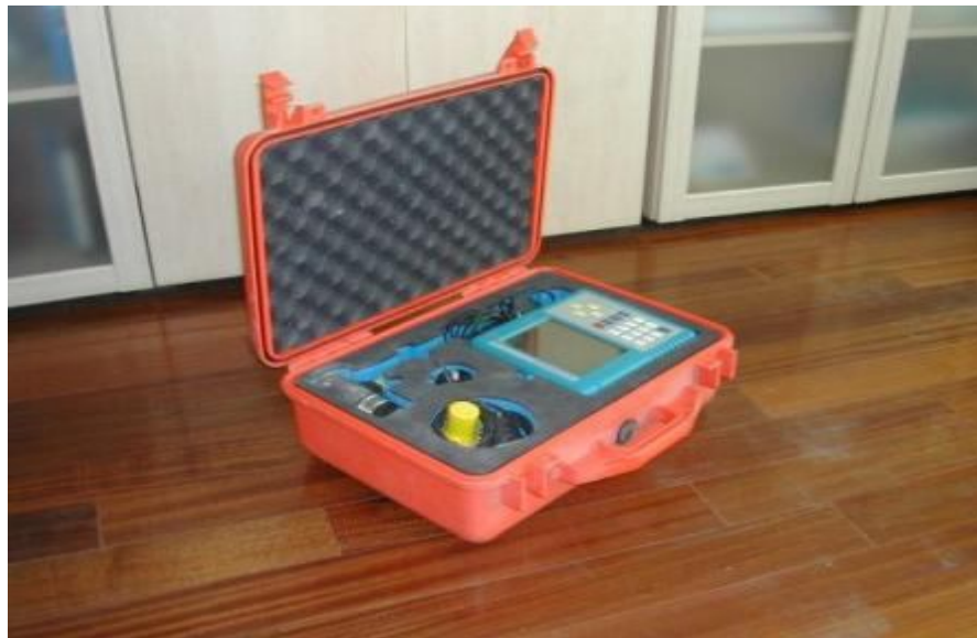
Şekil 3.23. Kazık süreklilik testi cihazı (Yıldız, 2011)
