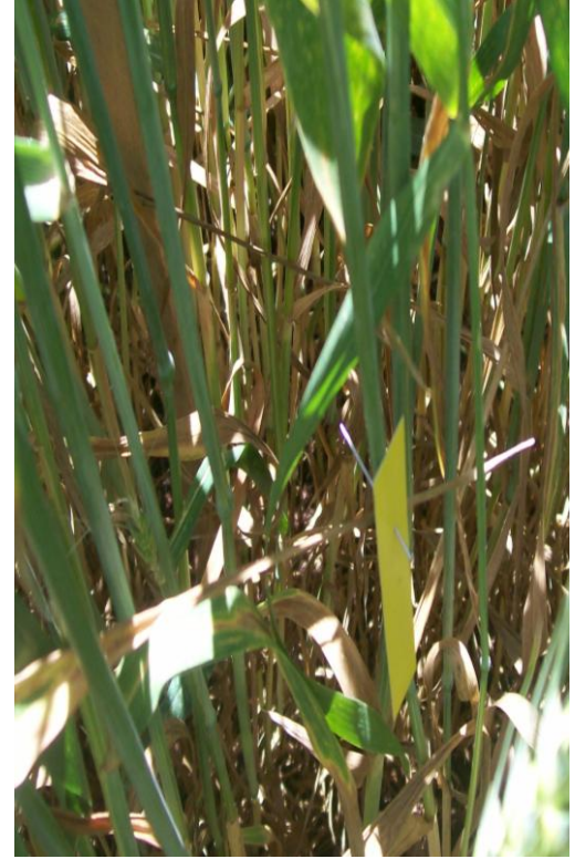
Şekil 3.12. Buğday bitkisinin sapına yerleştirilen suya duyarlı kart
