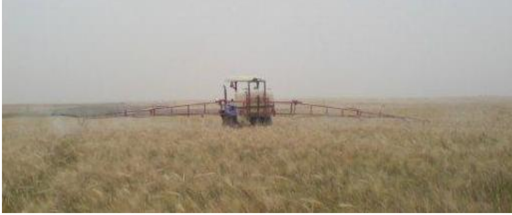
Şekil 4.6. Süne ilaçlaması sırasında püskürtme çubuğunun bağlantı noktalarında sabit bir bağlantı sağlanamadığından dolayı çubuğun aşağı-yukarı hareketi
