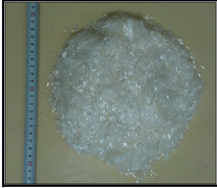
Şekil 3. 3. ECC üretiminde kullanılan PVA lifi
