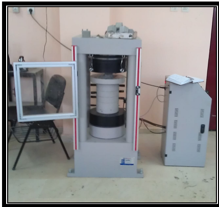
Şekil 3. 17. Basınç dayanımı a) Test cihazı ve b) Küp numuneleri
