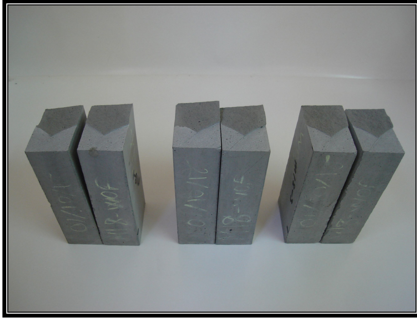
Şekil 3. 16. Matris tokluğu kesin çentik derinlikleri ölçümü
