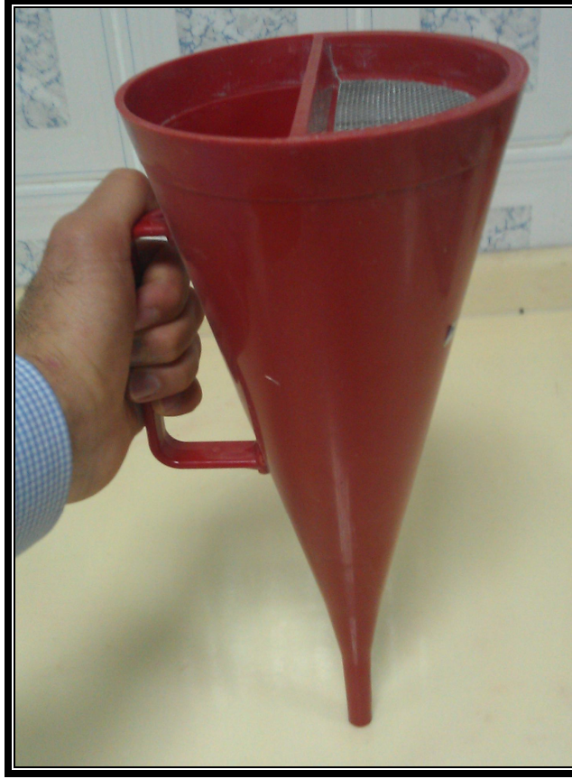
Şekil 3. 8. Marsh hunisi deney aparatı
