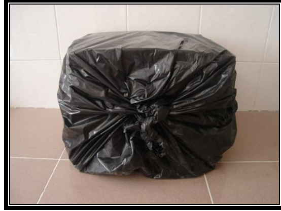
Şekil 3. 5. ECC numunelerinin poşette 7 gün kür edilmesi
