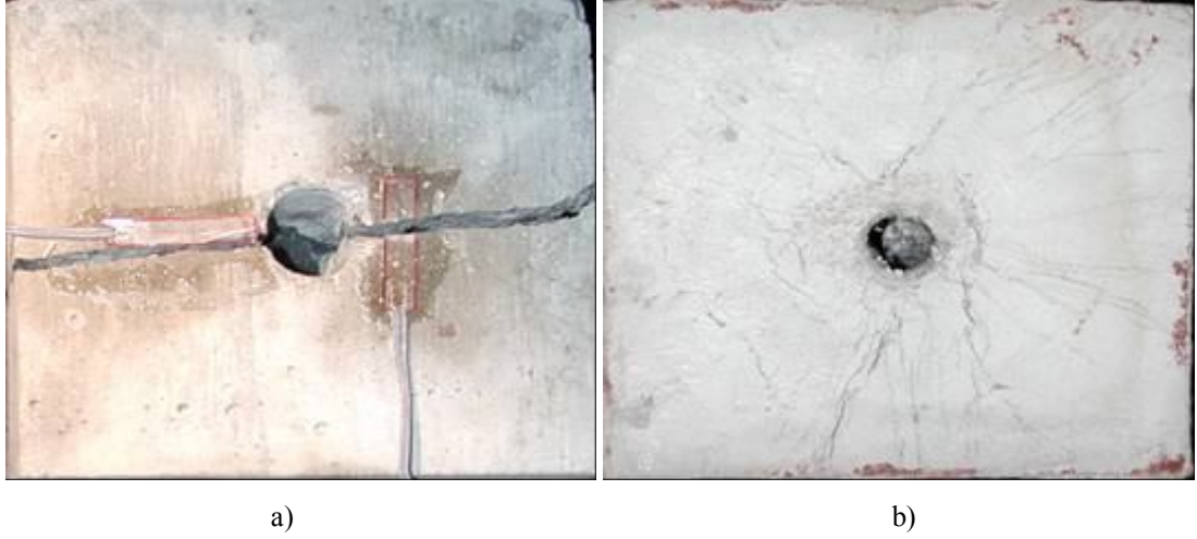
Şekil 2. 3. Kırılma modları a) Beton numunesi ve b) ECC numunesi (Miyazato ve Hiraishi, 2005; Kanda ve ark., 2003)
