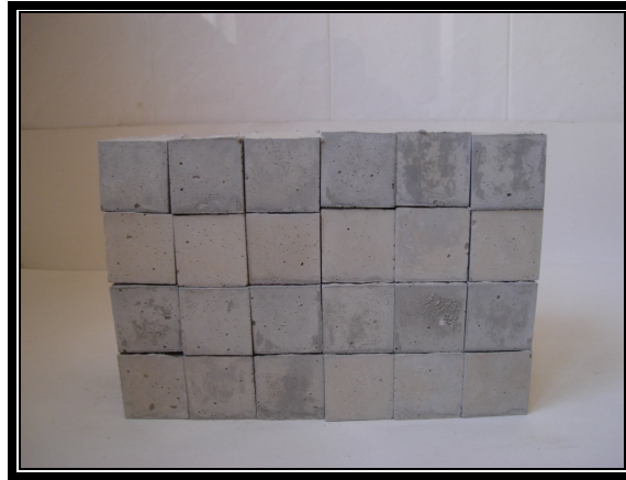
Şekil 3. 6. ECC numunelerinin oda şartlarında muhafaza edilmesi
