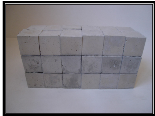
Şekil 3. 17. Basınç dayanımı a) Test cihazı ve b) Küp numuneleri
