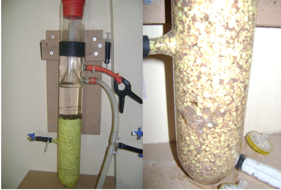
Şekil 3.9. Sadece elementel kükürt (3,0-5,0 mm) ile doldurulmuş akışkan yataklı kolon (AYR-1) reaktöre ait fotoğraf
