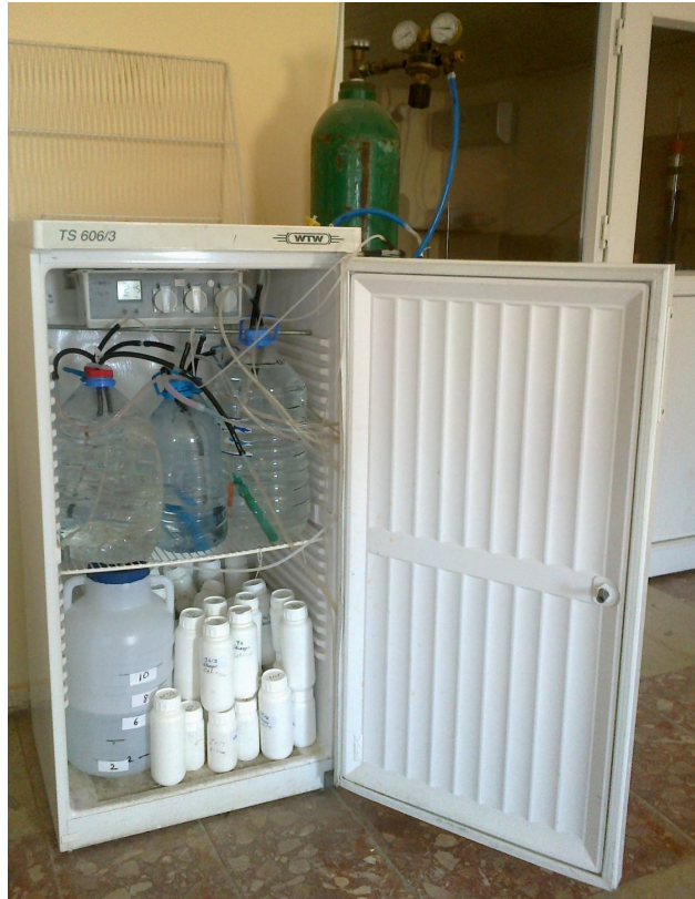
Şekil 3.4. 4 °C'de çalıştırılan buzdolabındaki besin tankları
