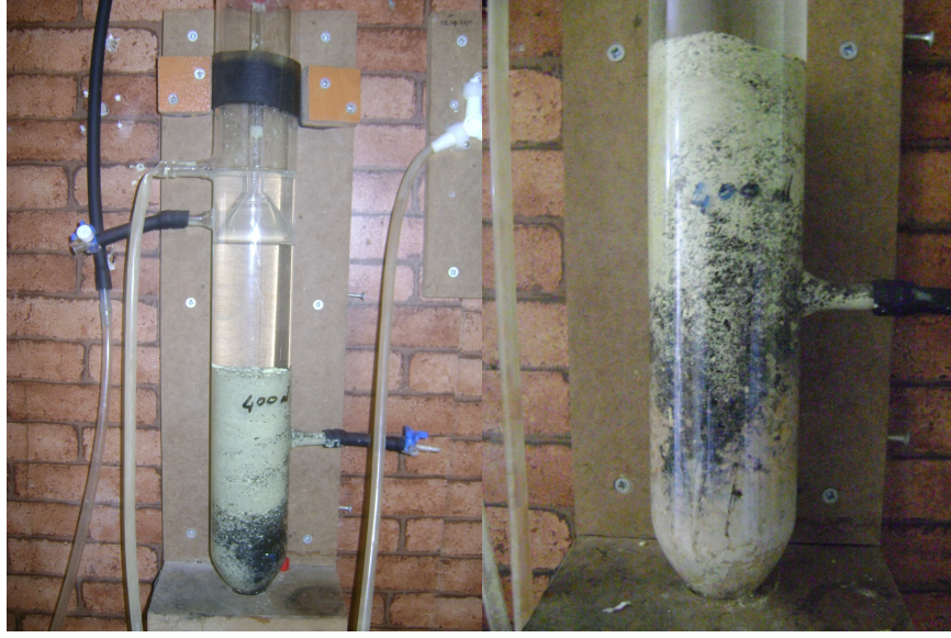
Şekil 3.7. 2/3 ve 1/3 hacim oranlarında kükürt (0.5-1mm) ve aktif karbon (1-1.5 mm) ile doldurulmuş sabit yataklı kolon-2 reaktörüne ait fotoğraf
