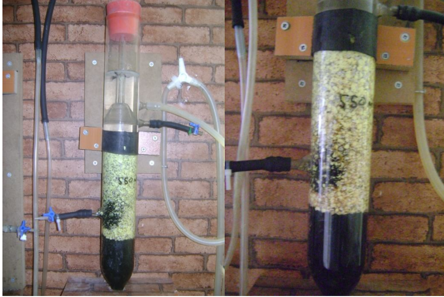
Şekil 3.8. Elementel kükürt (3,0-5,0 mm), kireç taşı (1,0-3,0 mm) ve aktif karbon (1,5-2,0 mm) ile doldurulmuş sabit yataklı kolon-3 reaktörüne ait fotoğraf
