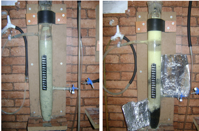
Şekil 3.5. Elementel kükürt, kireç taşı ve aktif karbon ile doldurulmuş sabit yataklı kolon-1 reaktörüne ait fotoğraf
