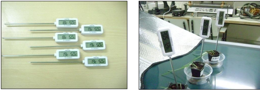
Şekil 3.16. Batırma tip termometreler
