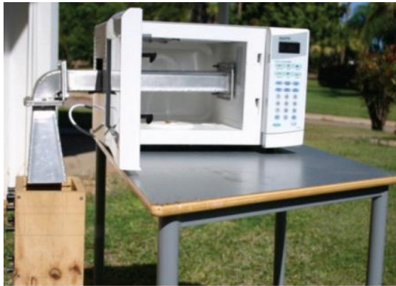
Şekil 2.1. Dalga kılavuzu yoluyla mikrodalga'nın hedefe yönlendirilmesi (Brodie, 2012)
