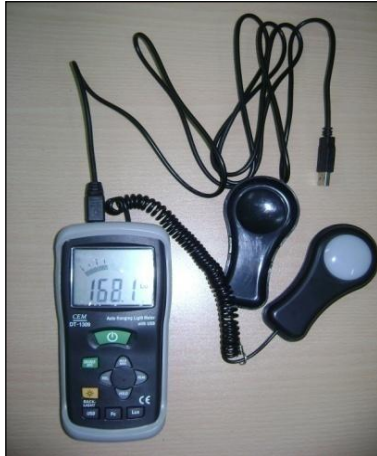
Şekil 3.11. Aydınlanma şiddeti ölçüm cihazı
