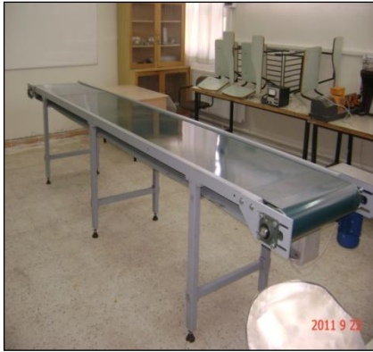
Şekil 3.4. Konveyör bant ve hız kontrol sürücüsü
