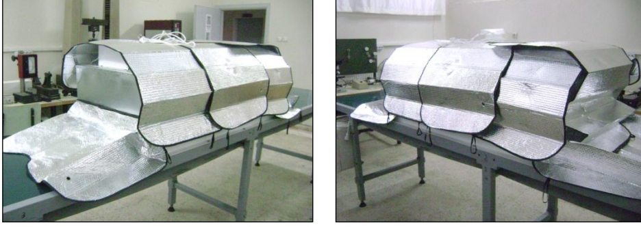
Şekil 3.8. Tünel mikrodalga geçirmez malzeme ile örtülmüş
