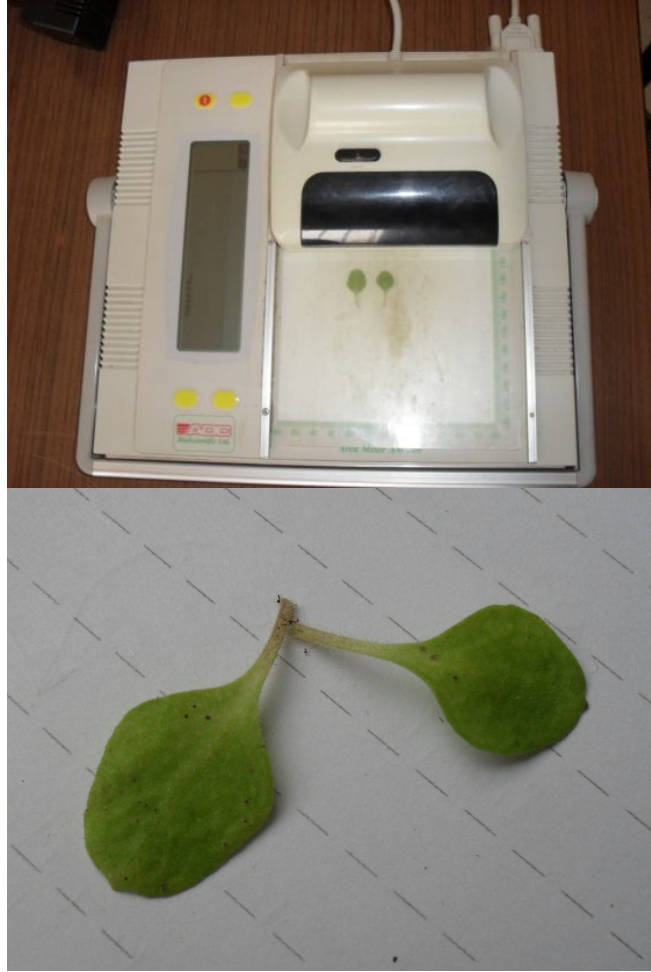
Şekil 3. 6. Yaprak alan ölçer ile kotiledon yaprak alan ölçümü
