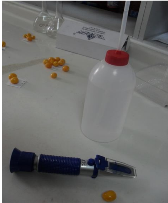
Şekil 3. 11. Refraktometre ile SÇKM ölçümü
