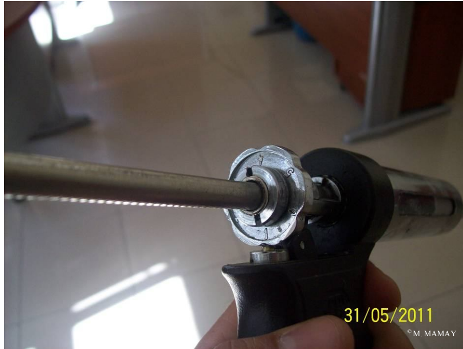
Şekil 3.2. ÇET feromonunun uygulanmasında kullanılan ayarlanabilir tabanca
