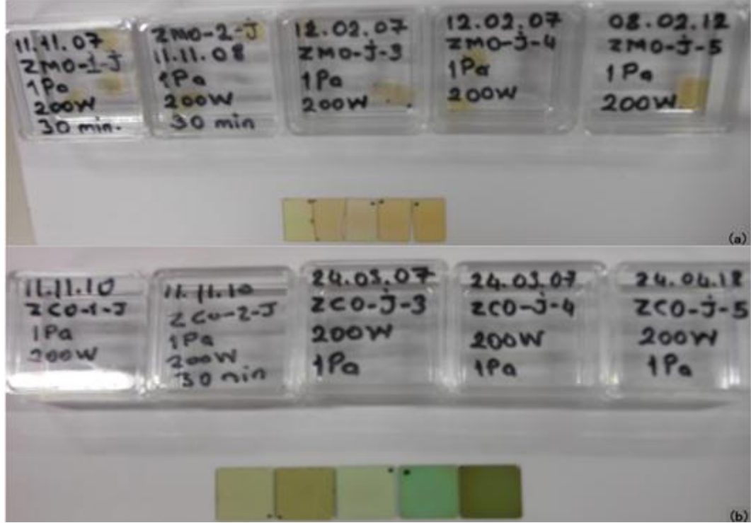
Şekil 3.14. Magnetron püskürtme tekniği ile üretilen (a) Zn_{1-x}Mn_xO ve (b) Zn_{1-x}Co_xO ince filmleri
