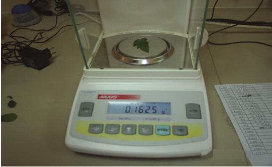
Şekil 3.3. Hasat sonrası yaprak yaş ağırlığının hassas terazide tartılması
