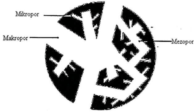
Şekil 2.3. Aktif karbonun gözenek yapısı ( şematik olarak) (Roy, 1995).
