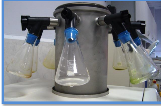
Şekil 3.5. Liyofilizasyon cihazında alkolün uzaklaştırılması
