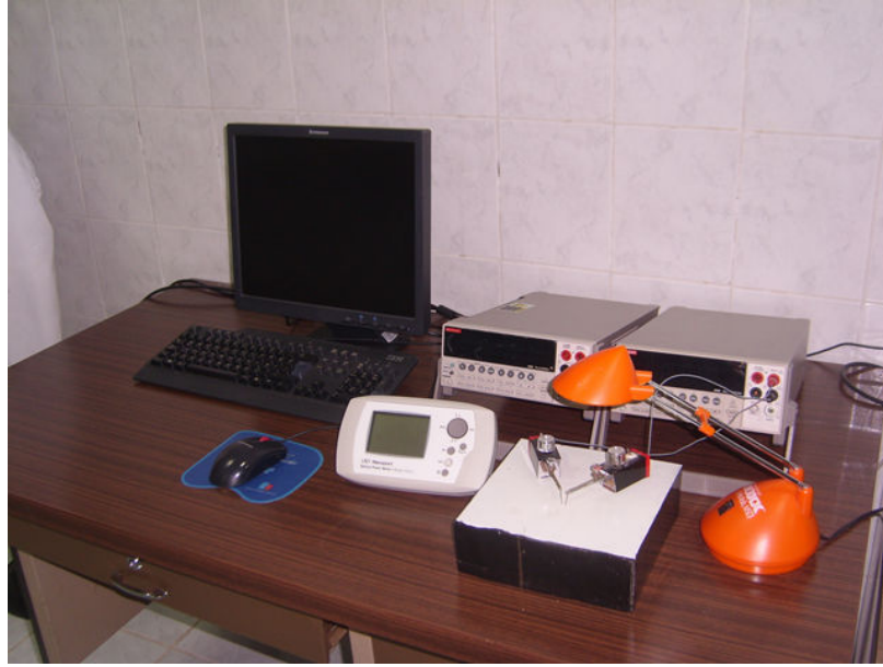
Şekil 3.13. Güneş pillerinin I-V ölçümünlerinde kullanılan sistem
