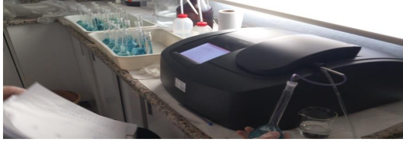
Şekil 4.17. Saksılardan alınan toprak örneklerinde üreaz aktivitesi analizinin yapılması
