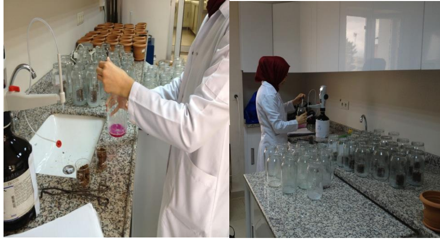
Şekil 4.2. Saksılardan alınan toprak örneklerinde CO 2 oluşum analizinin yapılması
