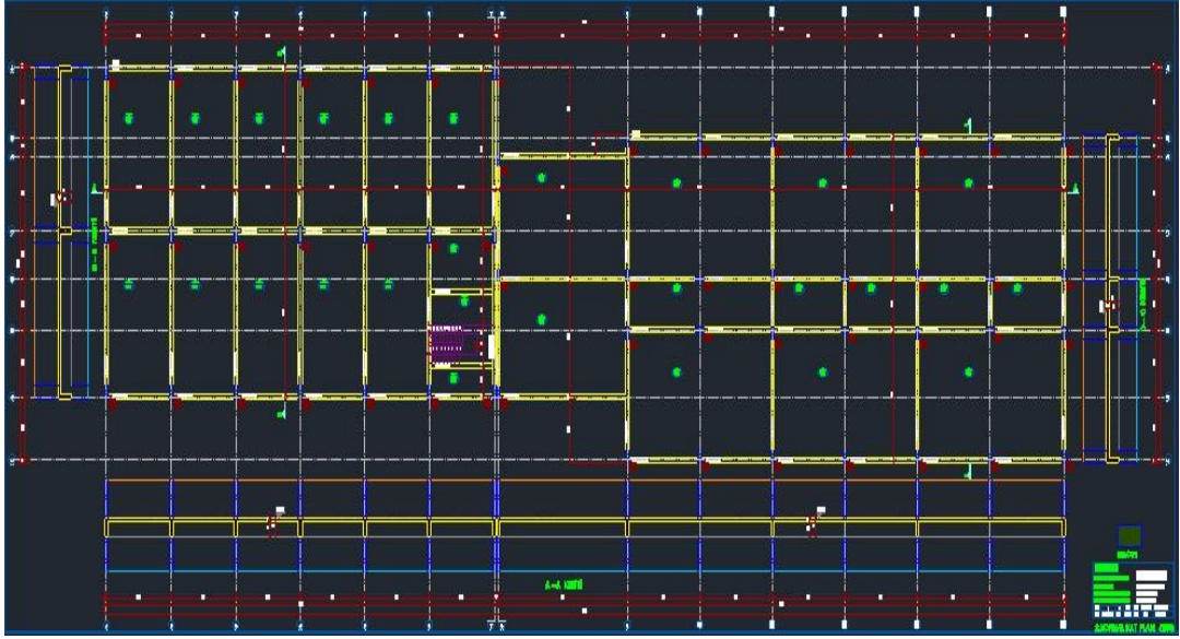
Şekil 4.4. B blok (5 katlı) - a blok (2 katlı) zemin kat statik röleve planı
