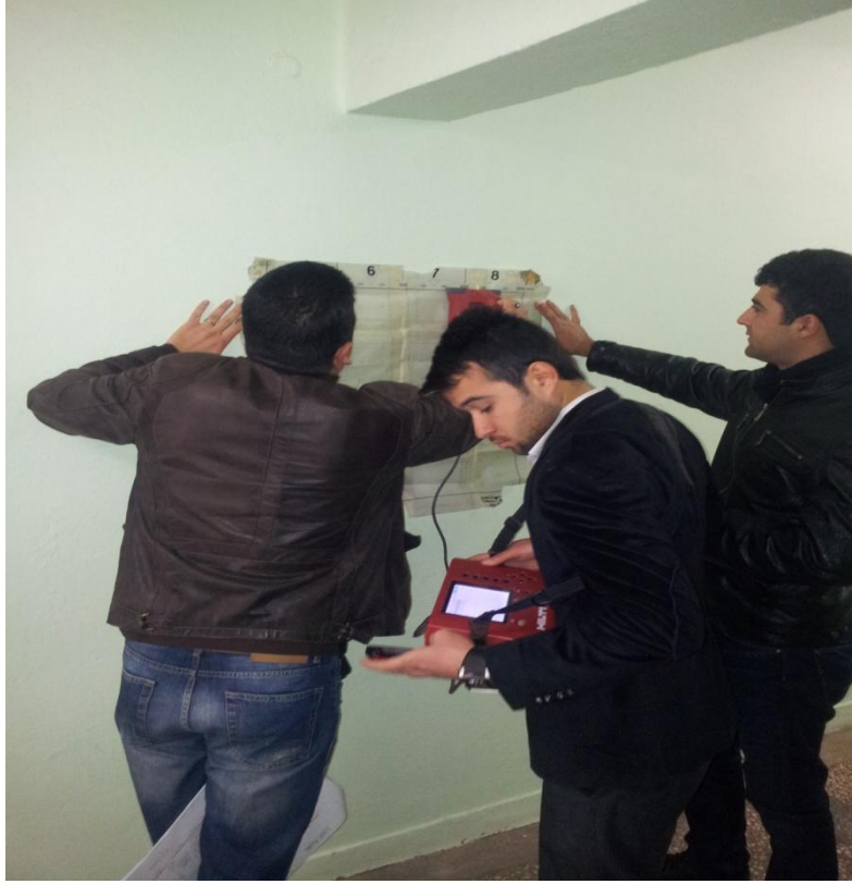
Şekil 3.3. Donatı tespit yöntemi
