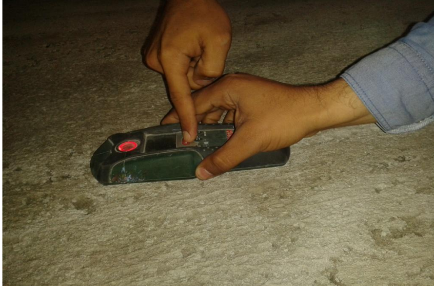
Şekil 3.1. Karot almadan önce taşıyıcı elemanlardaki donatı tespiti
