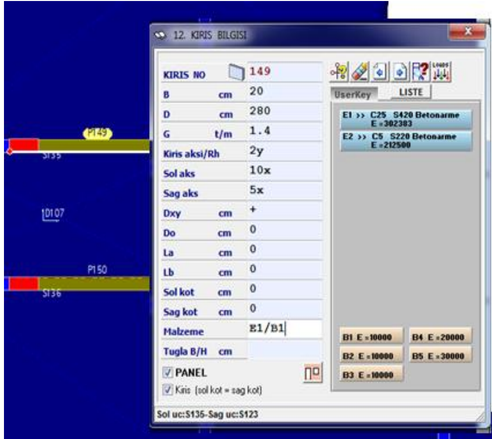
Şekil 4.17. A blok güçlendirilmiş P149 perdenin malzeme bilgileri
