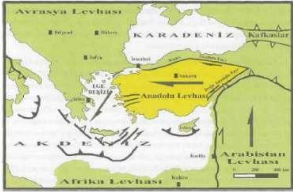
Şekil 1.10. Anadolu levhasının batıya kayma mekanizması
