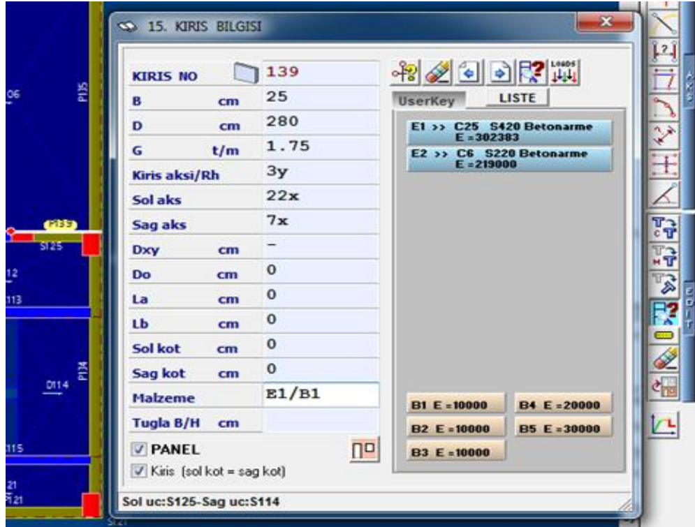
Şekil 4.25. B blok güçlendirilmiş P139 perdenin malzeme bilgileri
