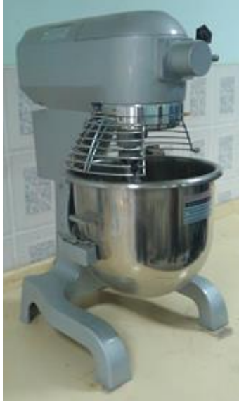
Şekil 4.15. Karışım işleminde kullanılan 25 lt kapasiteli mikser
