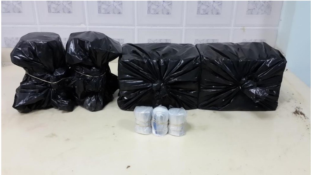
Şekil 4.20. 1. Grup deney numunelerinin poşette 28 günlük kür edilmesi
