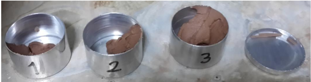
Şekil 4.7. Likit limit ve plastik limit değerlerinin belirlenmesi
