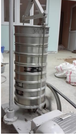
Şekil 4.1. Elek seti ve sarsma düzeneği
