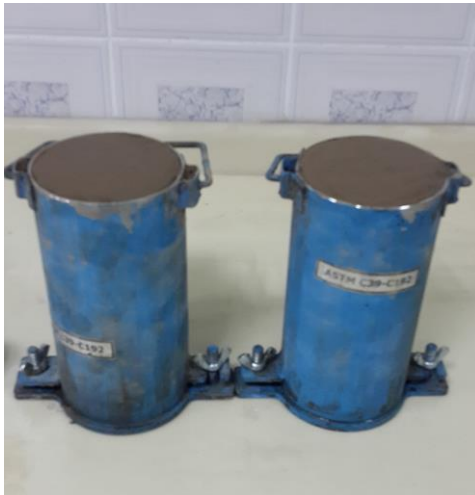
Şekil 4.18. 100x200 mm'lik Silindir numuneler
