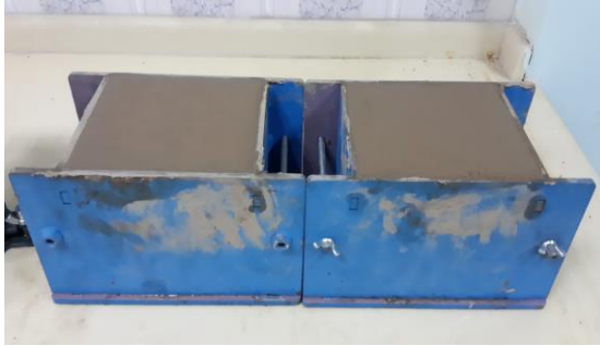
Şekil 4.17. 150x150x150 mm'lik Küp numuneler
