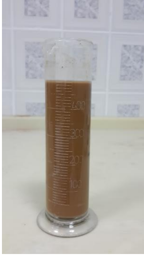
Şekil 4.3. Pipet yöntemi için hazırlanan süspansiyon
