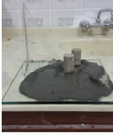
(a) Harcın cam levhaya yerleştirilmesi (b) Numune yüzeylerinin düzlenmesi
