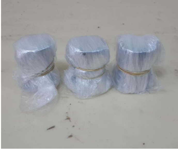
Şekil 4.19. 30x60 mm'lik Silindir numunelerin poşette 28 gün kür edilmesi
