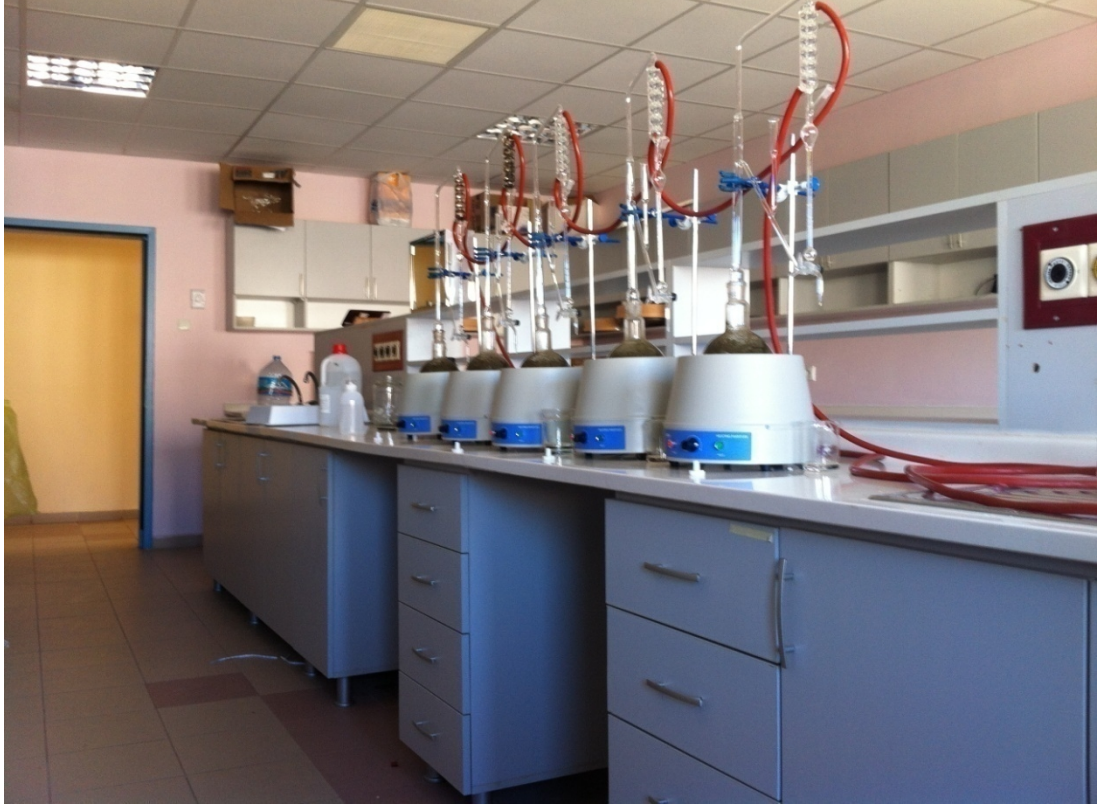
Şekil3.20. Uçucu yağ distilasyonu esnasında bir görünüm
