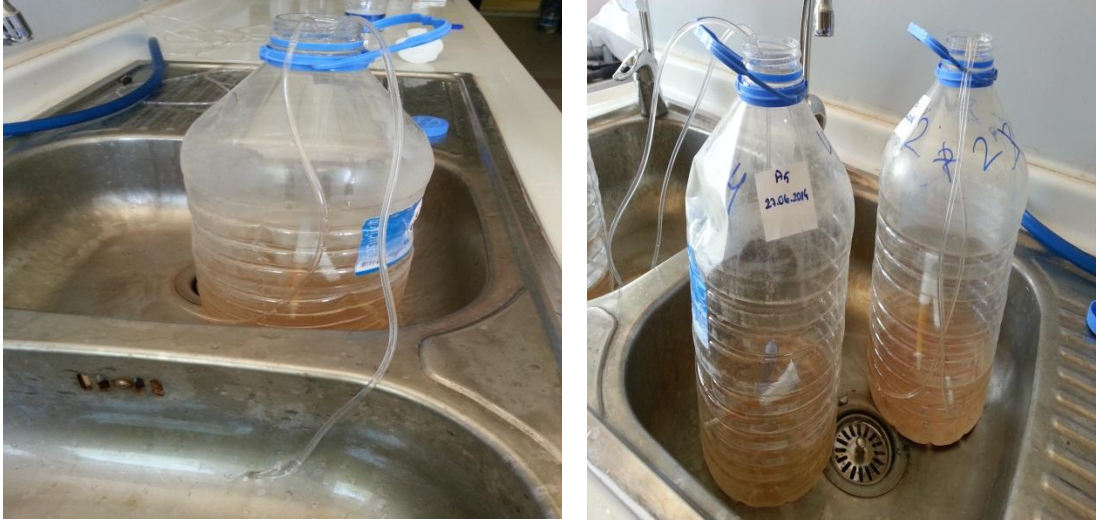
Şekil 3.8. Serum hortumu ile şişelerdeki su miktarının azaltılması
