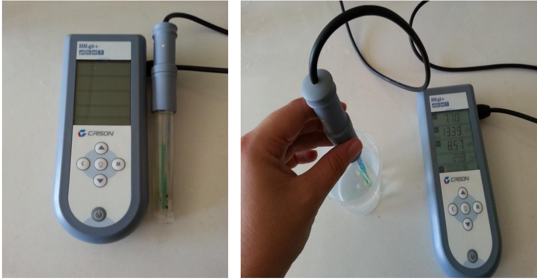
Şekil 3.7. Crison MM40+ cihazı ile pH, EC ve TDS analizlerinin yapılışı
