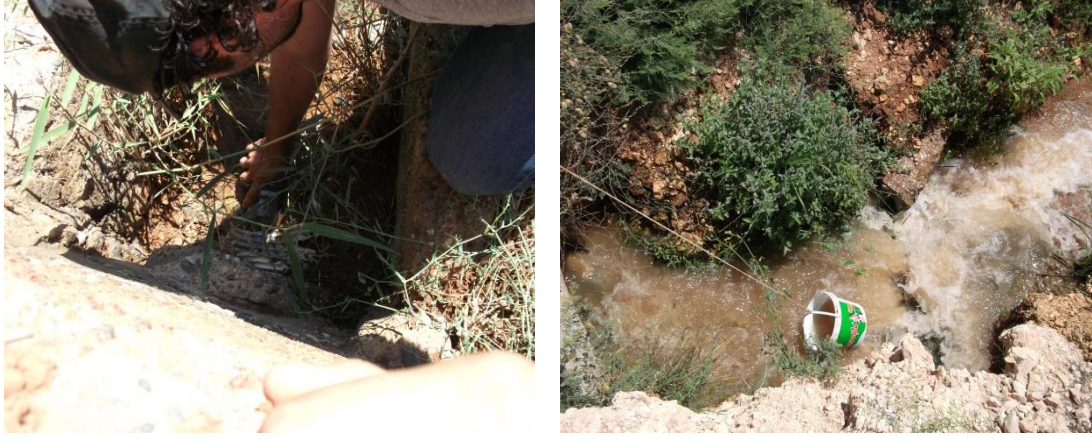
Şekil 3.5. Toplayıcı dren borularından su örneklerinin alınması
