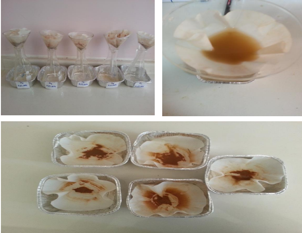
Şekil 3.9. Sedimentin filtre kağıdı ile süzülmesi
