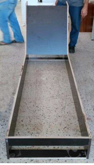
Şekil 3.5. Kesilen plywood (ahşap) parçaların tutkal ve cıvatalarla birbirine tutturulması
