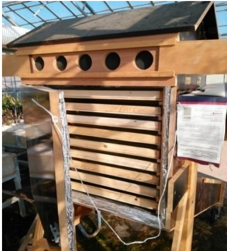
Şekil 3.15. GEKM' nin kurutma kabini ve kurutma tepsilerinin dizilişi
