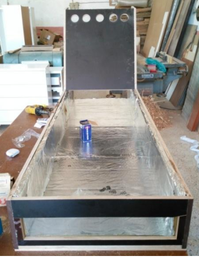
Şekil 3.6. Kurutma makinesinin ısı yalıtımı ile kaplanması
