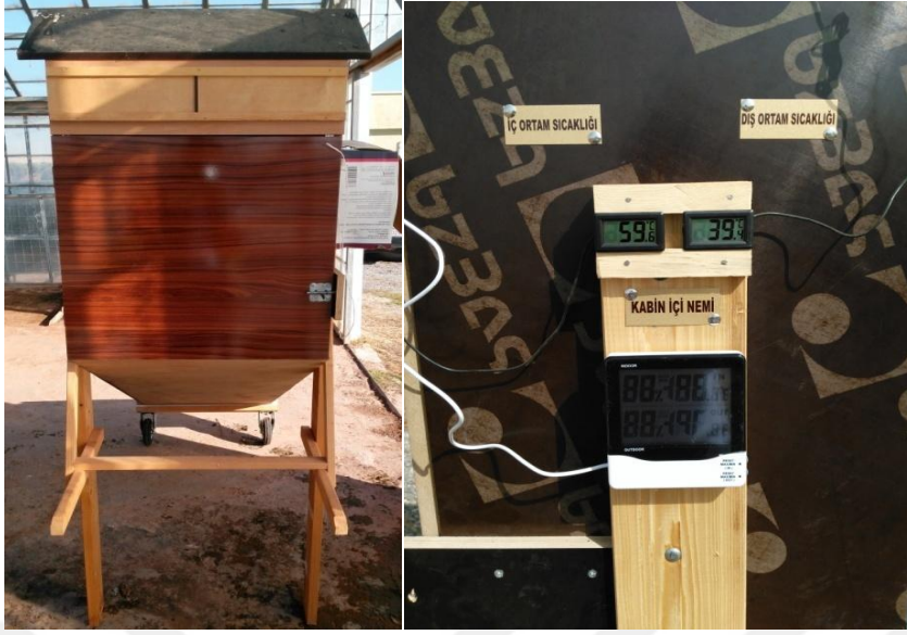
Şekil 3.13. GEKM'nin arkadan görünüş ve yan tarafta ise ölçüm cihazları
