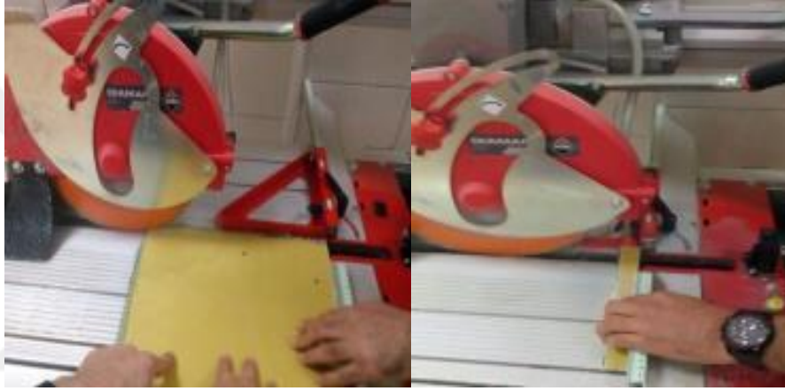
Şekil 3.14. Deney numunelerinin kesme tezgâhında kesilmesi
