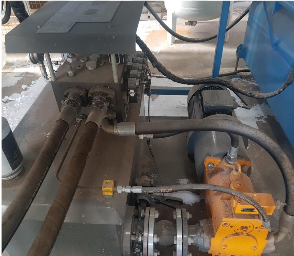
Şekil 4.12. Hidrolik motorlarına örnek
