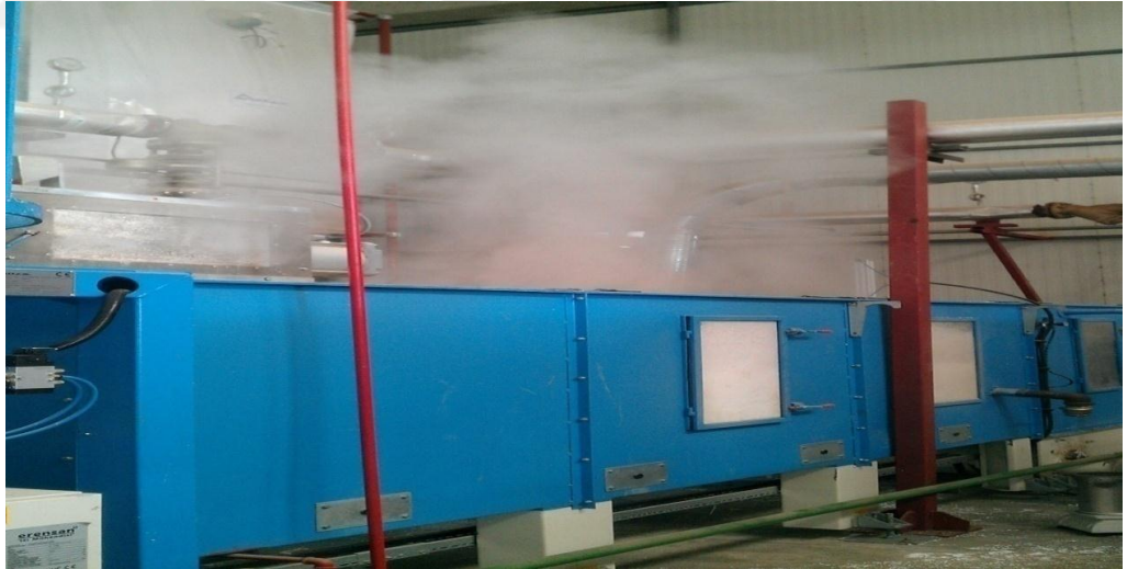
Şekil 4.5. Akışkan yataklı kurutucuda kurutma
