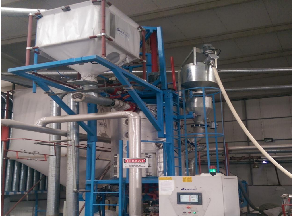
Şekil 4.2. Eps şişirme makinesi
