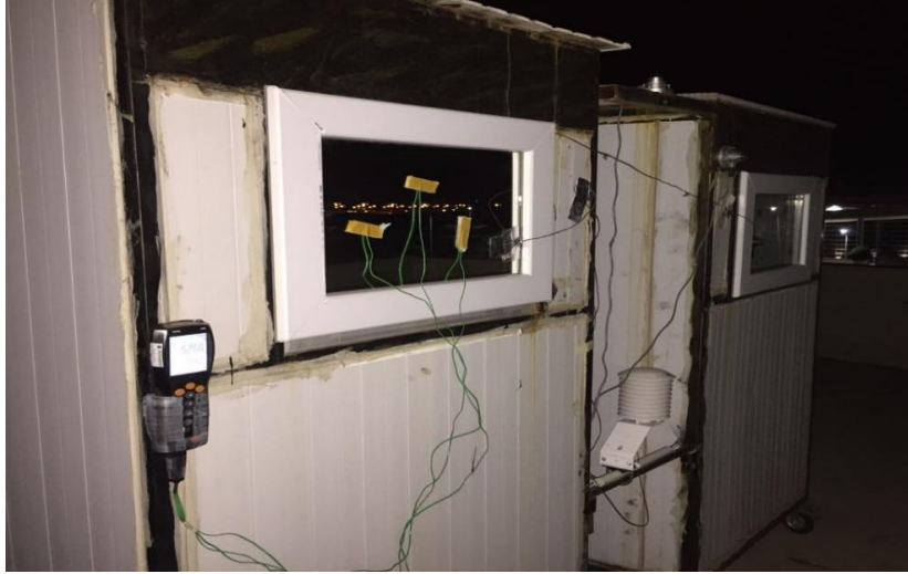
Şekil 3. 14. Aynanın toplam ısı transfer katsayısı ölçümü
