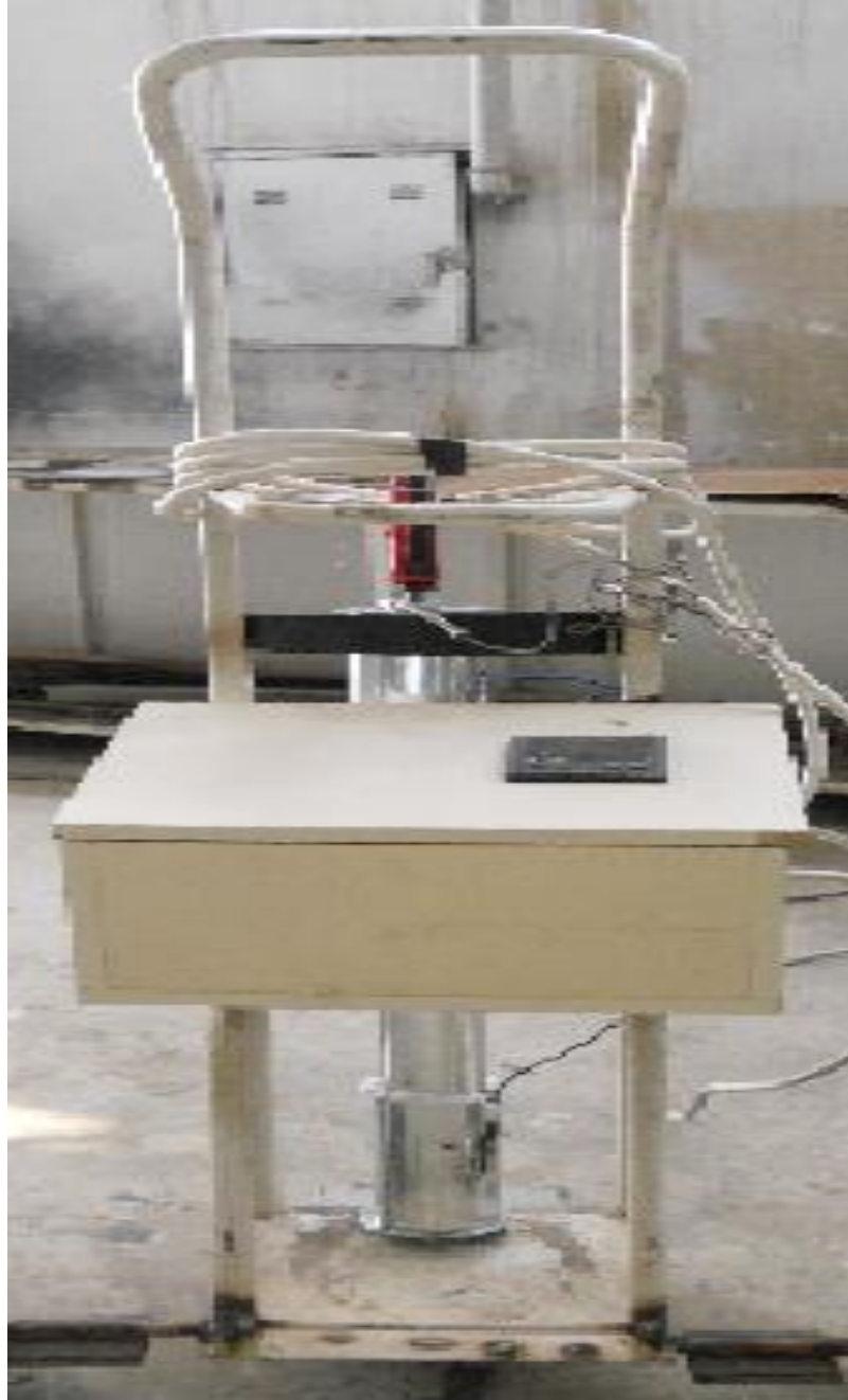
Şekil 5.2. Dijital göstergeli köpük ısıtma kontrol sistemi
