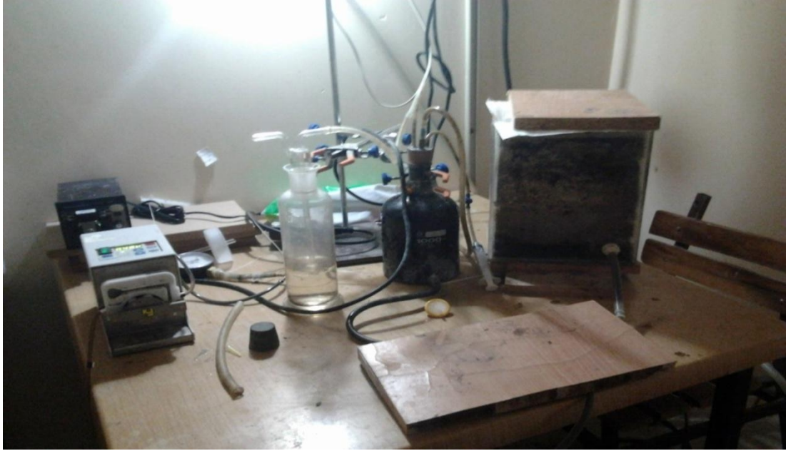
Şekil 3.2. Anaerobik reaktör, gaz metre, ısıtma tertibatı ve pompa görüntüsü
