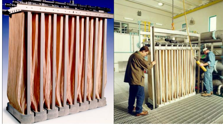
Şekil 2.5. Bir Membran Kaseti ve Bu Kasetin Tank İçine Yerleştirilmesi
