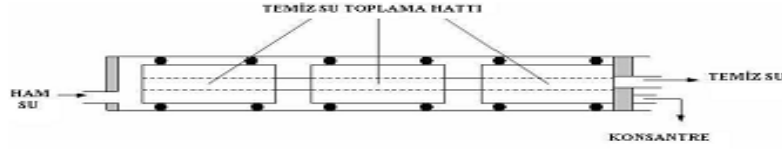
Şekil 2.15. Çoklu spiral sarımlı membranların çalışma prensibi
