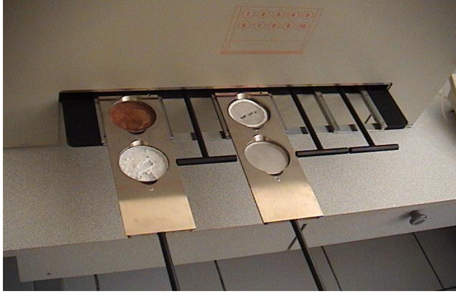
Şekil 3.7. Gaz akışlı orantılı bir sayıcıya ait düzenek (Değerlier, 2007)
