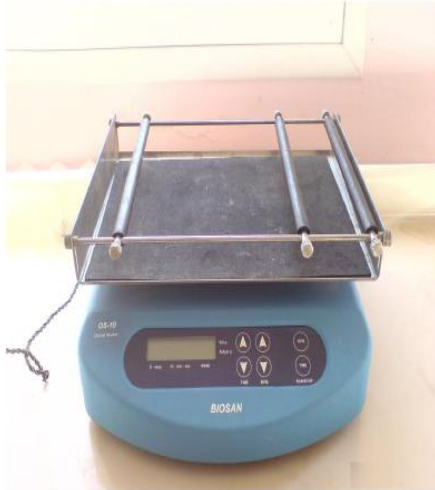
Şekil 3.4. Adsorpsiyon reaksiyonlarının gerçekleştirildiği karıştırıcı (Biosan) ve reaksiyon sonrasında katı –sıvı faz ayrımının yapıldığı santrifuj (Elektro mag)
