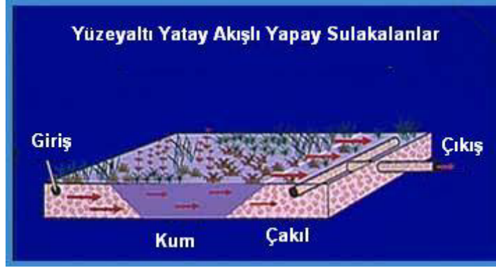
Şekil 1.14. Yatay yüzey altı akışlı yapay sulak alan akış yönü (ÇOB, 2010)
