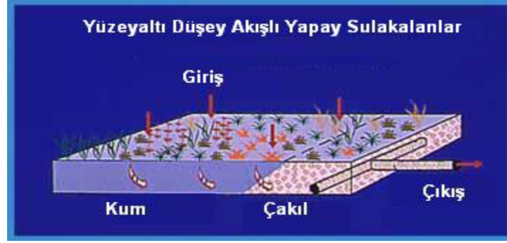
Şekil 1.18. Yüzeyaltı düşey akışlı yapay sulak alan akış yönü (ÇOB,2010)
