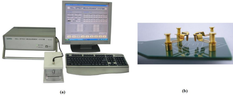
Şekil 3.10. (a) Ecopia HMS-300 Hall ölçüm sistemi ve (b) Numune probu (URL-4)
