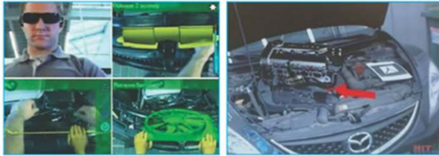
Şekil 1.6. Bakım sırasında bir aracın AGT yardımıyla montaj sıralarının takibi (BWM, 2009)
