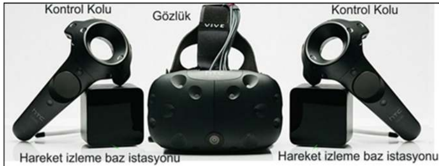
Şekil 3.25. Sanal gerçeklik gözlüğü, kontrol kolları ve baz istasyonları
