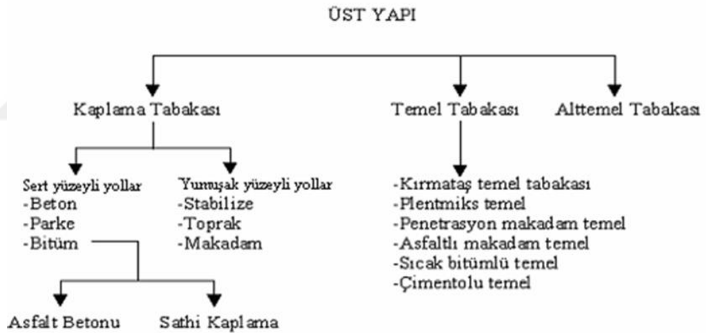
Şekil 1. 2. Yol üst yapı tabaka çeşitleri şematik gösterimi (Kuloğlu ve ark. , 2006)
