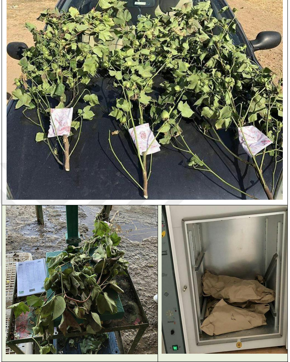
Şekil 3.10. Yaş ve kuru ağırlık için alınan pamuk örnekleri, örneklerin yaş ağırlığının alınması ve kuru ağırlık almak için etüvde 65°C'de kurutulan bitkiler
