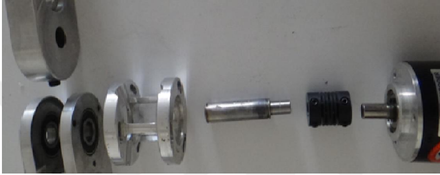
Şekil 3.8. L_0 üst ucu rulmanları ile L_1 elemanı alt yuvası mil ve enkoder bağlantısı
