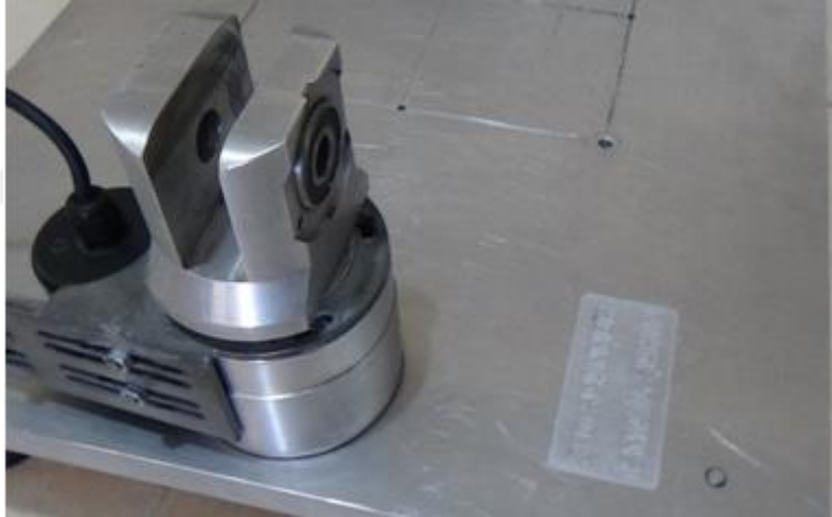
Şekil 3.6. L_0 elemanının plaka üzerine montajı
