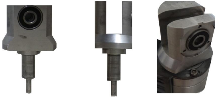
Şekil 3.2. L_0 elemanının görünüşleri ile tabla üzerine montajı
