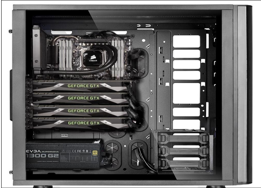
Şekil 3.1. Çoklu GPU iş istasyonu
