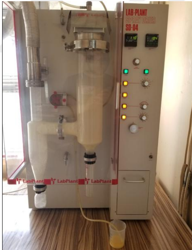
Şekil 4.1. Püskürterek kurutma aşamasından bir görüntü
