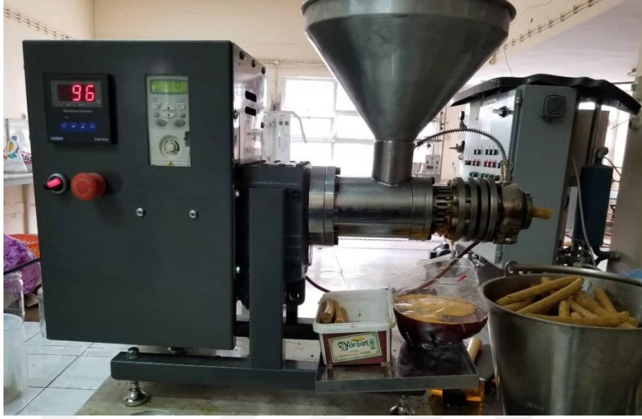
Şekil 3.2. Soğuk pres cihazı ve yağ elde edilmesi
