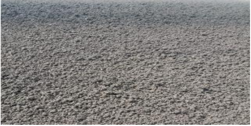
Şekil.4.3. Solar kurutmada kurutulmuş çamur
