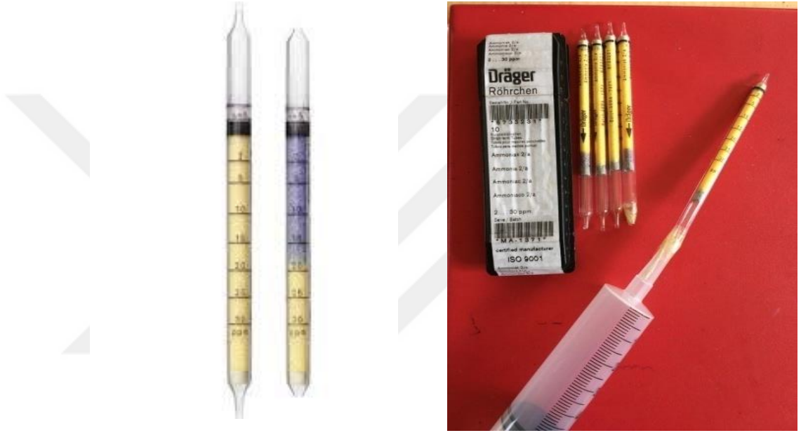
Şekil 3.3. Drager tüplerinin genel görünümü (soldaki resimde dragger tüpünün ölçüm anında baş kısımlarının kırılması ve amonyak ölçümünü sağlayan renk değişimi görülmektedir)
