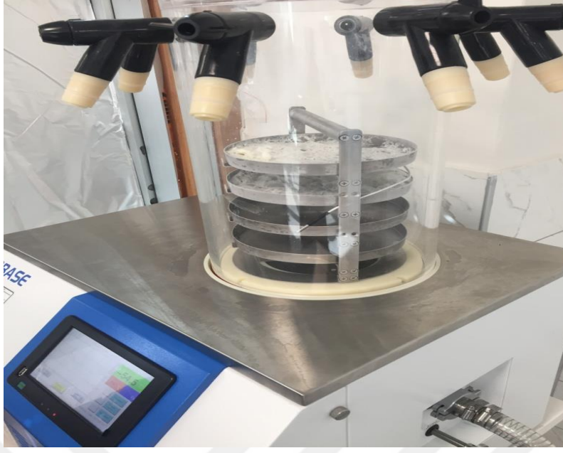
Şekil 3. 9. Trüf mantarının ( Tuber aestivum ) dondurarak kurutma ile enkapsülasyonu
