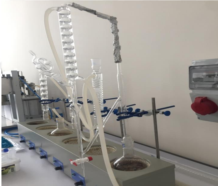
Şekil 3. 5. Trüf mantarının ( Tuber aestivum ) geleneksel yöntem ekstraksiyonu
