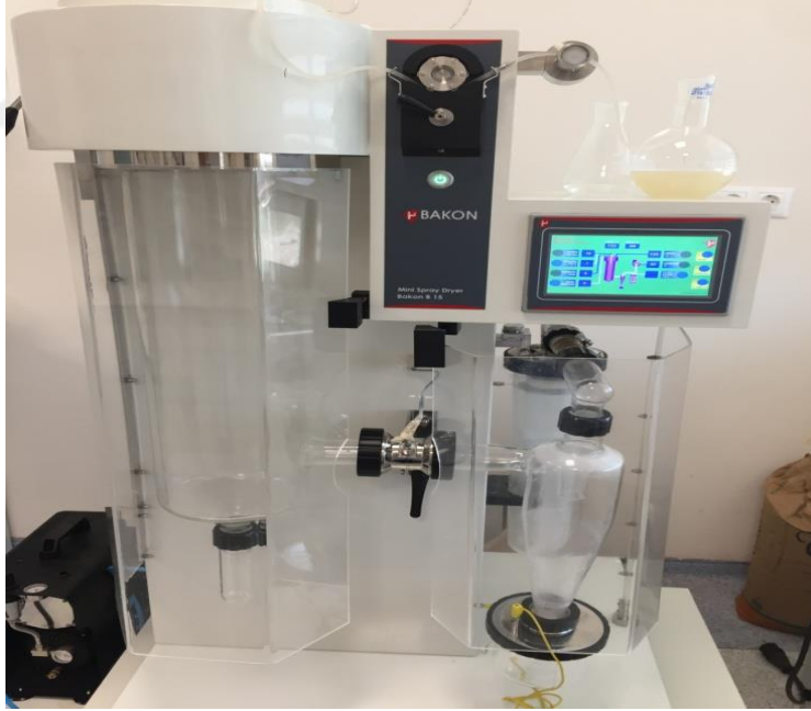
Şekil 3. 8. Trüf mantarının ( Tuber aestivum ) püskürtmeli kurutma ile enkapsülasyonu
