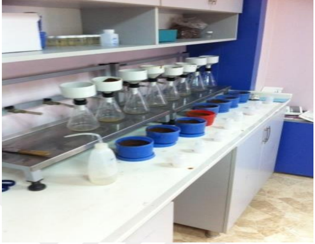
Şekil 3.9.Laboratuarda toprak analizindeki pH, EC analizi
