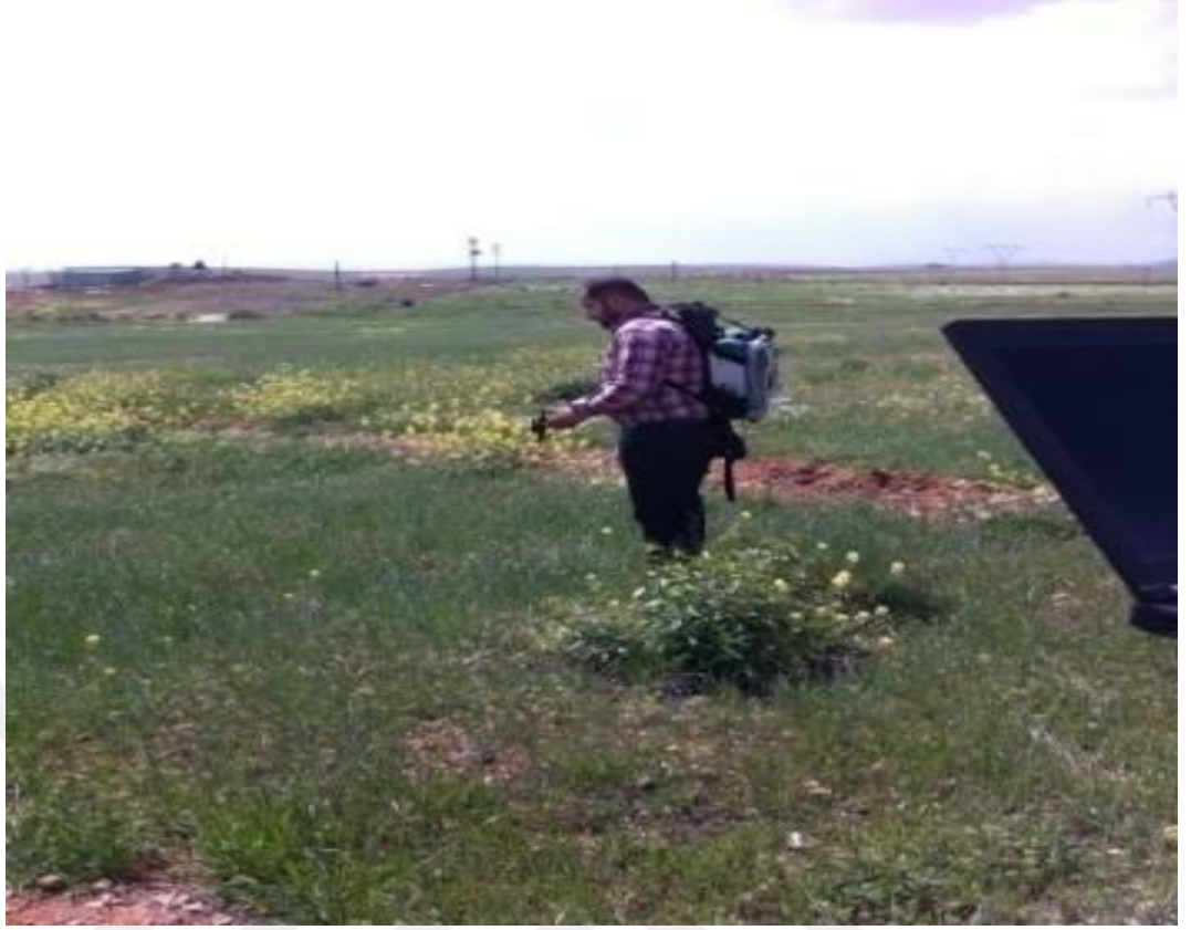
Şekil 3.16. Spektrodadyo metre ile bitki yansımalarının alımı
