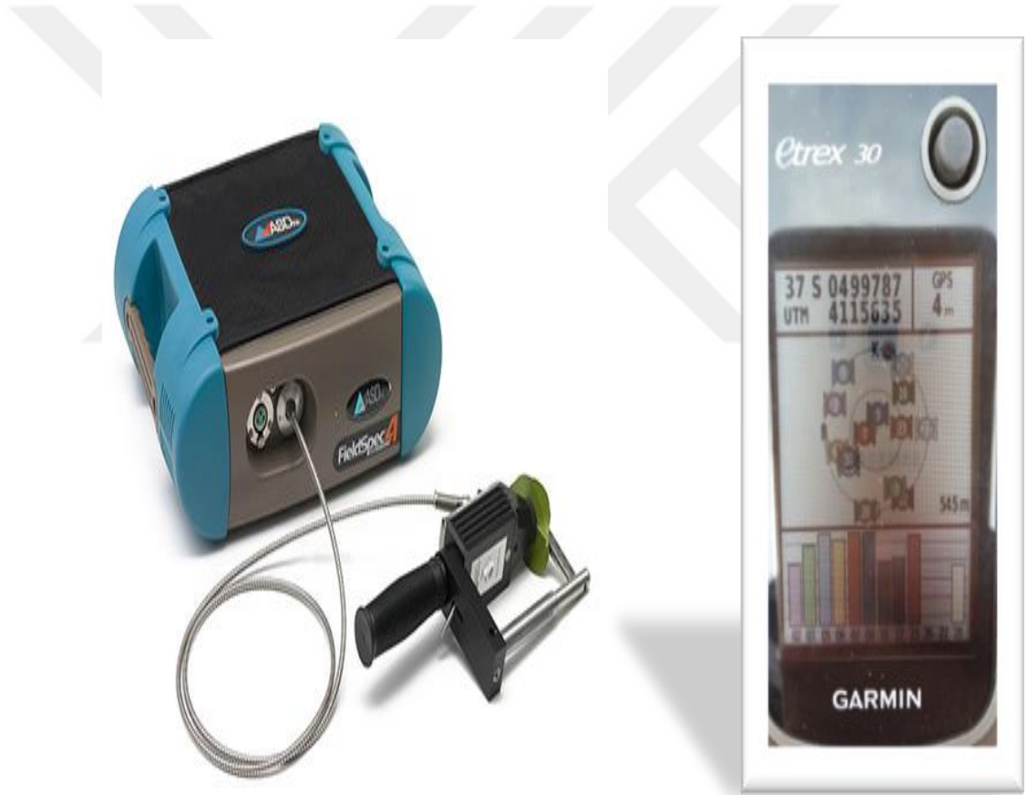
Şekil 3.15. Spektroradyometre cihazı ve koordinatların belirlenmesi
