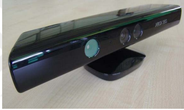
Resim-4: Kinect Hareket Algılayıcı Sensör.
