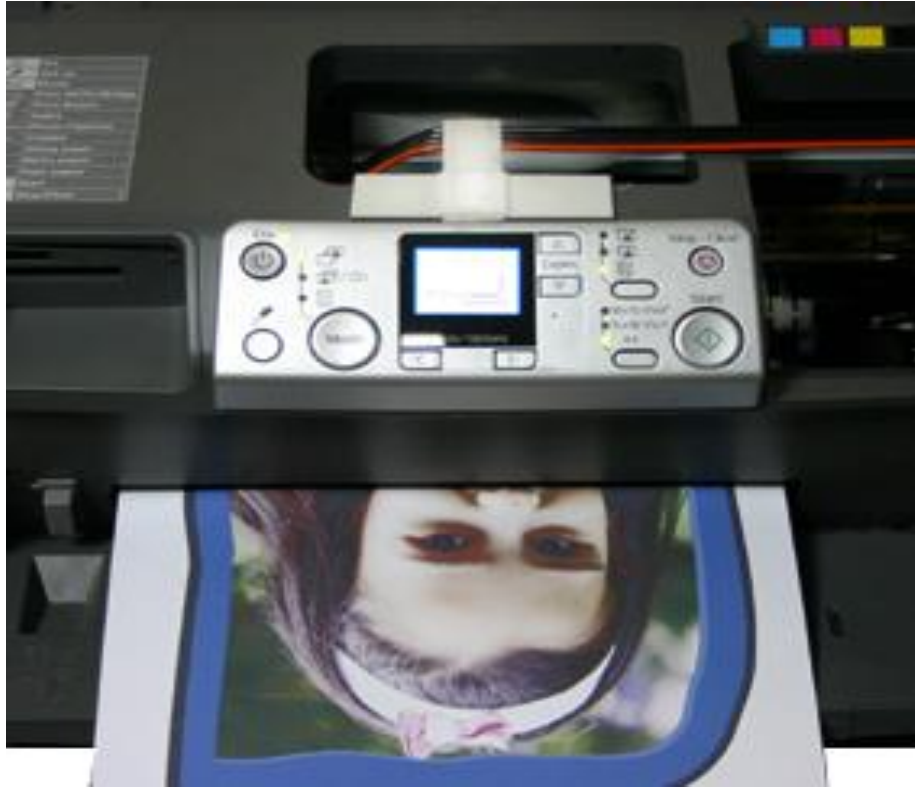
Şekil 4.5.1.3.Sublimasyon Printer ile t-shirt baskıya uygun ebatlarda süblimasyon transfer kağıdına ters çıktı alınır
