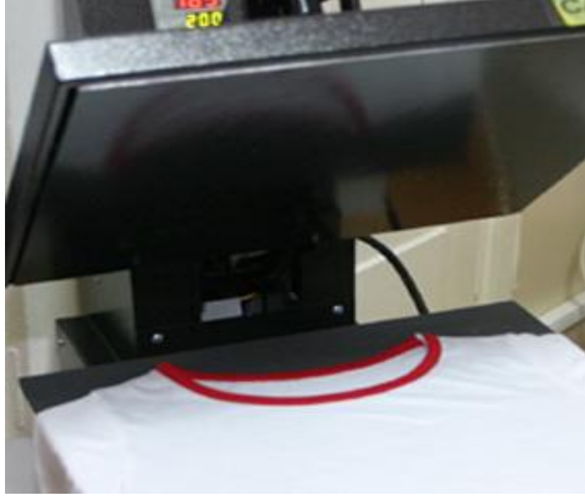
Şekil 4.5.1.4. Sublimasyon baskıya uygun t-shirt sıcak transfer presine yerleştirilir, press 200 C derece 60 saniye'ye ayarlanır
