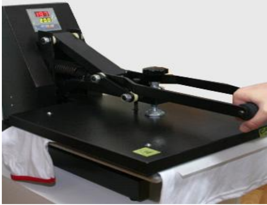
Şekil 4.5.1.6. Sıcak transfer presi kapatılır, yüksek basınçta 60 saniye preslenir
