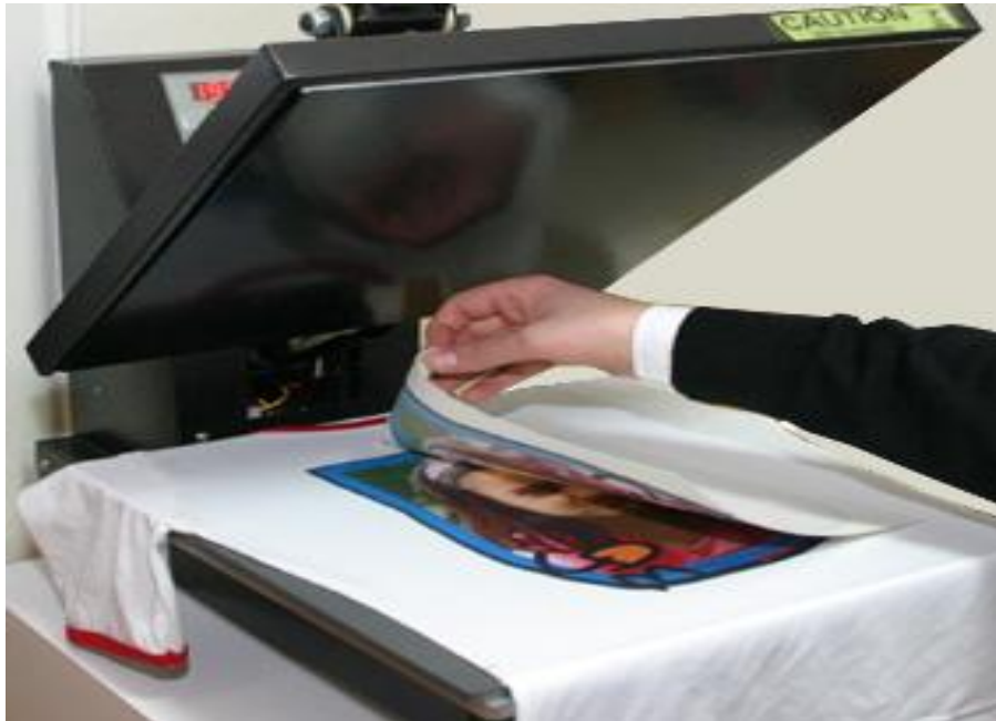
Şekil 4.5.1.7. Pres açılır, süblimasyon transfer kağıdı çıkartılır
