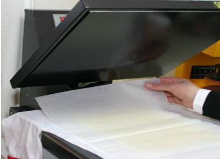
Şekil 4.5.1.5. Sublimasyon transfer kağıdı t-shirt'ün üzerine yerleştirilir
