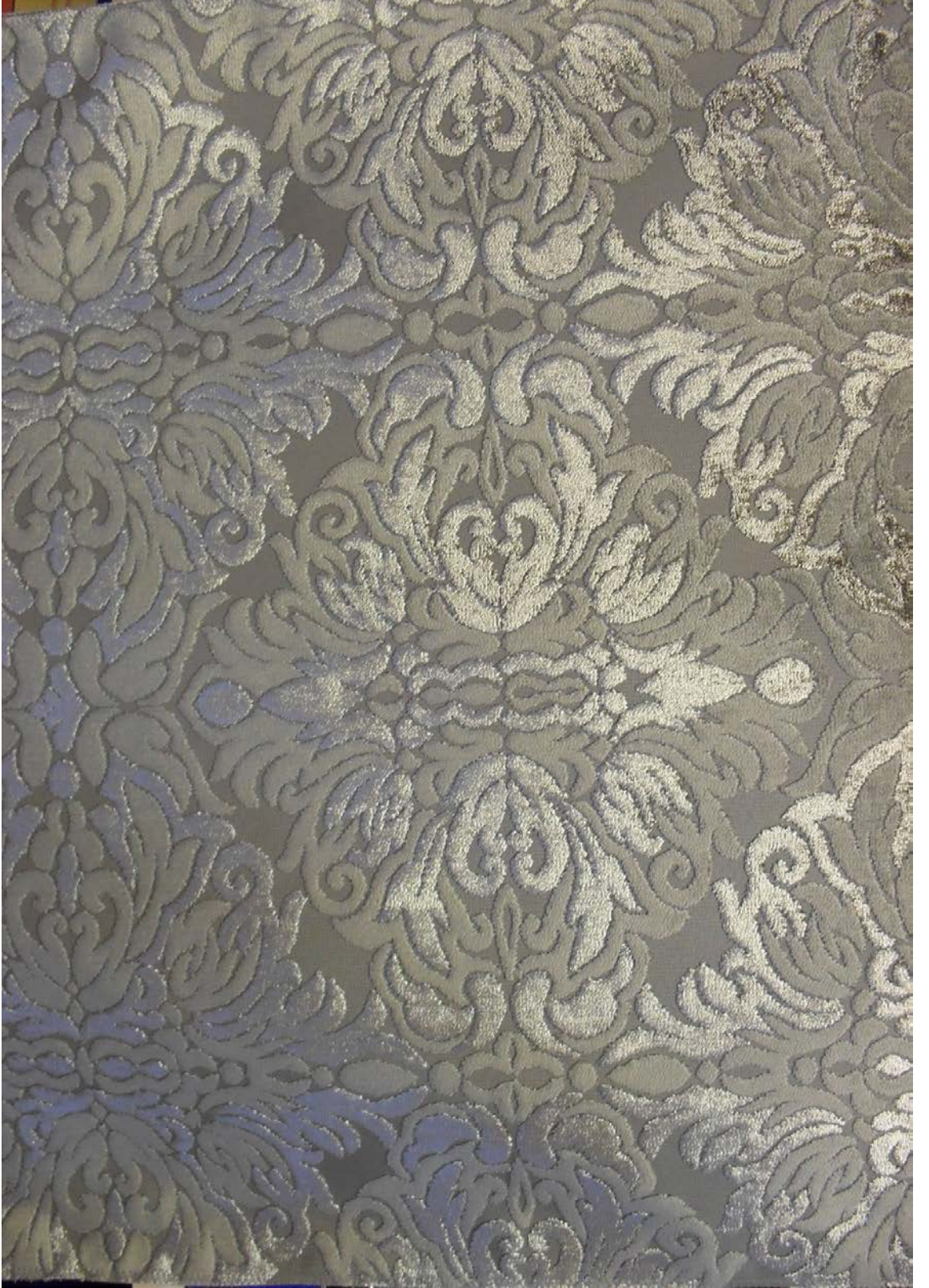
Şekil 9.41.: V Bağlama, Top Boya Tekniğiyle Dokunan 3-A Numaralı Kadife Kumaş Detayı
