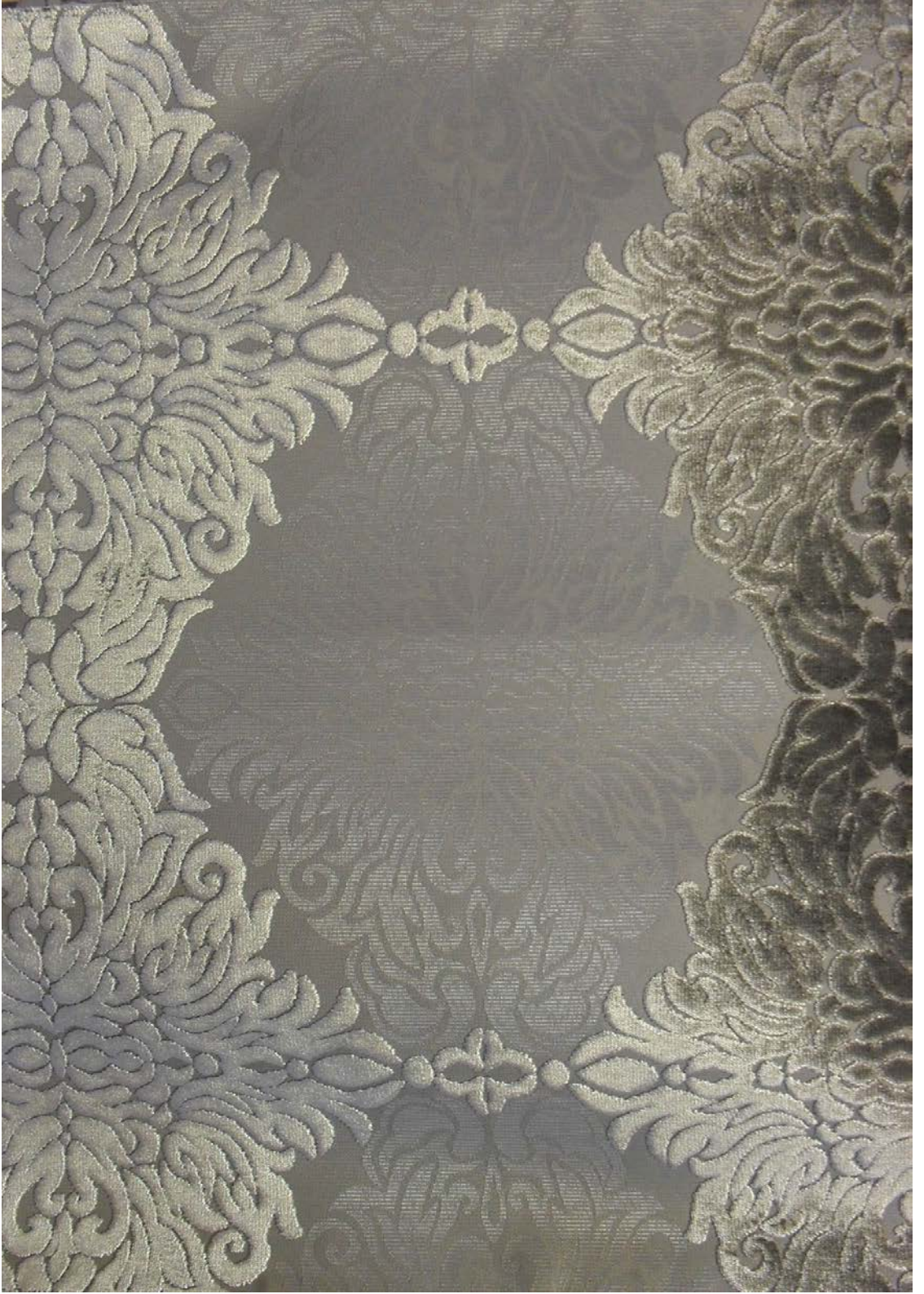
Şekil 9.42.: V Bağlama, Top Boya Tekniğiyle Dokunan 3-B Numaralı Kadife Kumaş Detayı ( Kombin )
