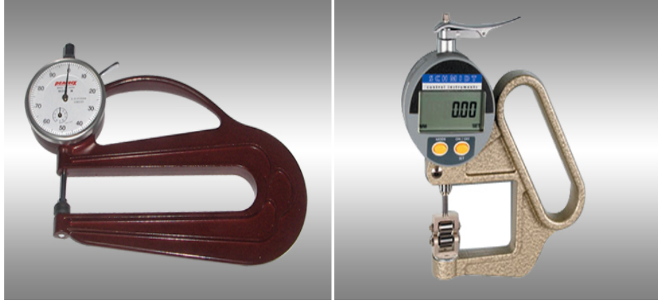
Şekil 9.5.: Kumaş Kalınlığını Ölçme Testi
