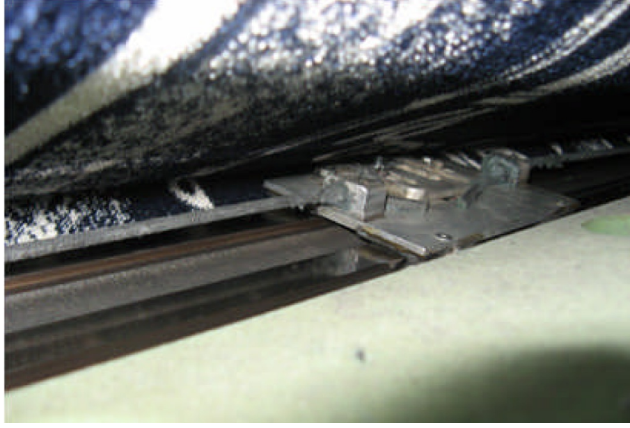
Şekil 5.4.: Üst ve Alt Kumaş Arasındaki Bıçağın Kesim İşlemi
