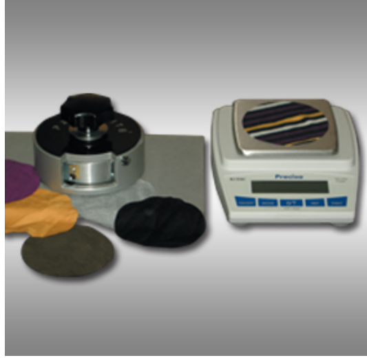
Şekil 9.1.: Gramaj Hesaplama Test Cihazı,
