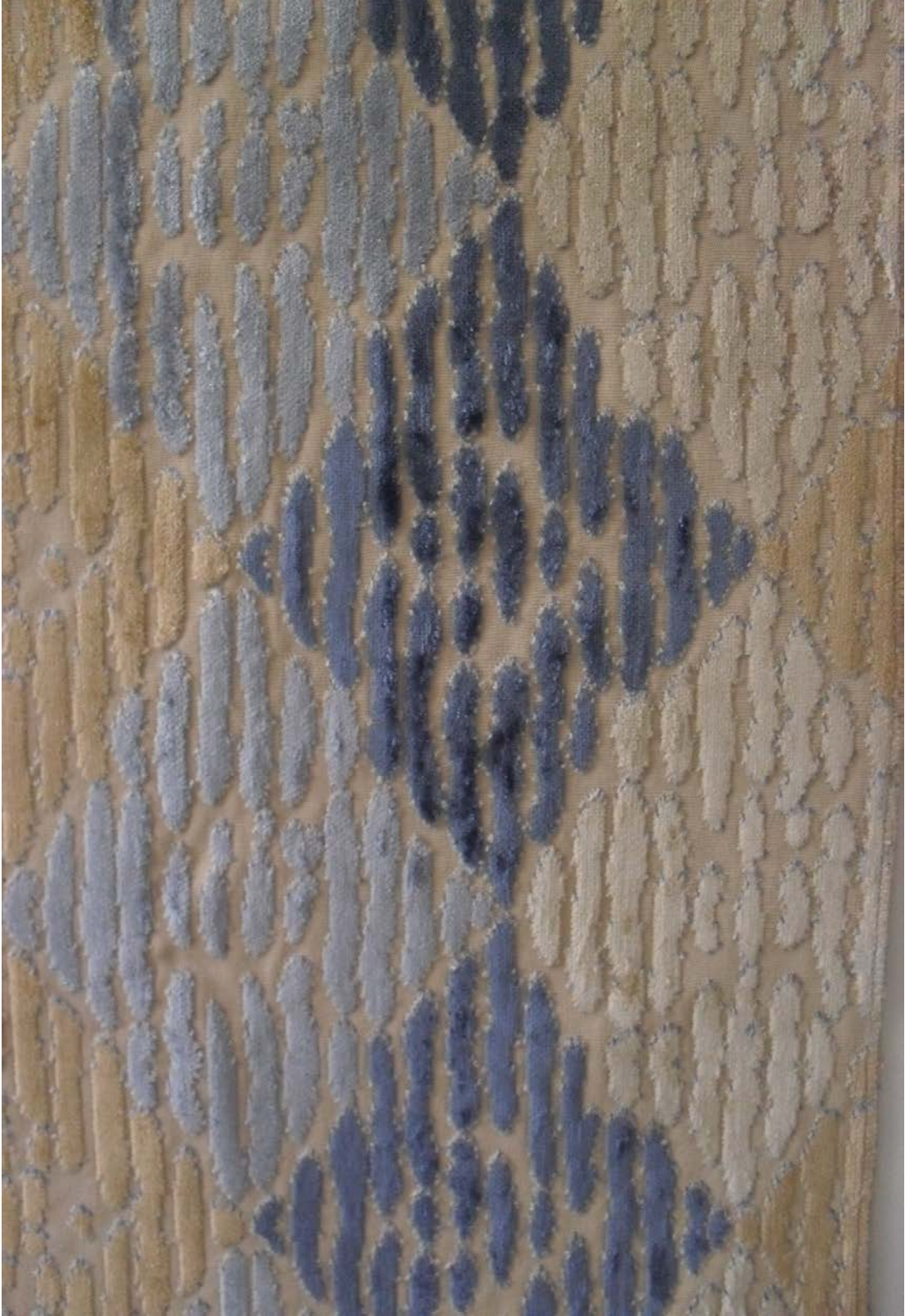
Şekil 9.48.: U Bağlama, 4 Chorlu, İplik Boyama Tekniğiyle Dokunan 5-A Numaralı Klasik Kadife Kumaş Detayı
