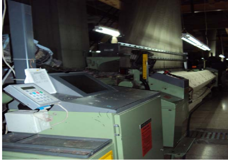
Şekil 3.1.: Kadife Tekstil Firmasında, Dornier Kadife Dokuma Makinası,
