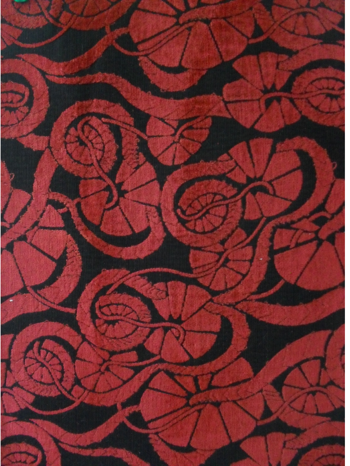
Şekil 9.56.: Atkıdan İşlemeli, Desen Şönil İplik, Zemin Akrilik ve Pes. İplik Torba Örgü Tekniğiyle Dokunan 6-A Numaralı Şönil Kumaş Detayı
