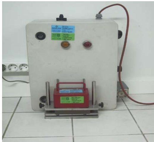
Şekil 9.9.: Ter ve Su Haslığı Test Cihazı,
