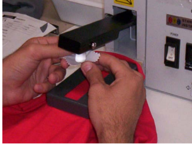
Şekil 9.14.: Sürtme Bezinin Sürtme Uçuna Takılışı,
