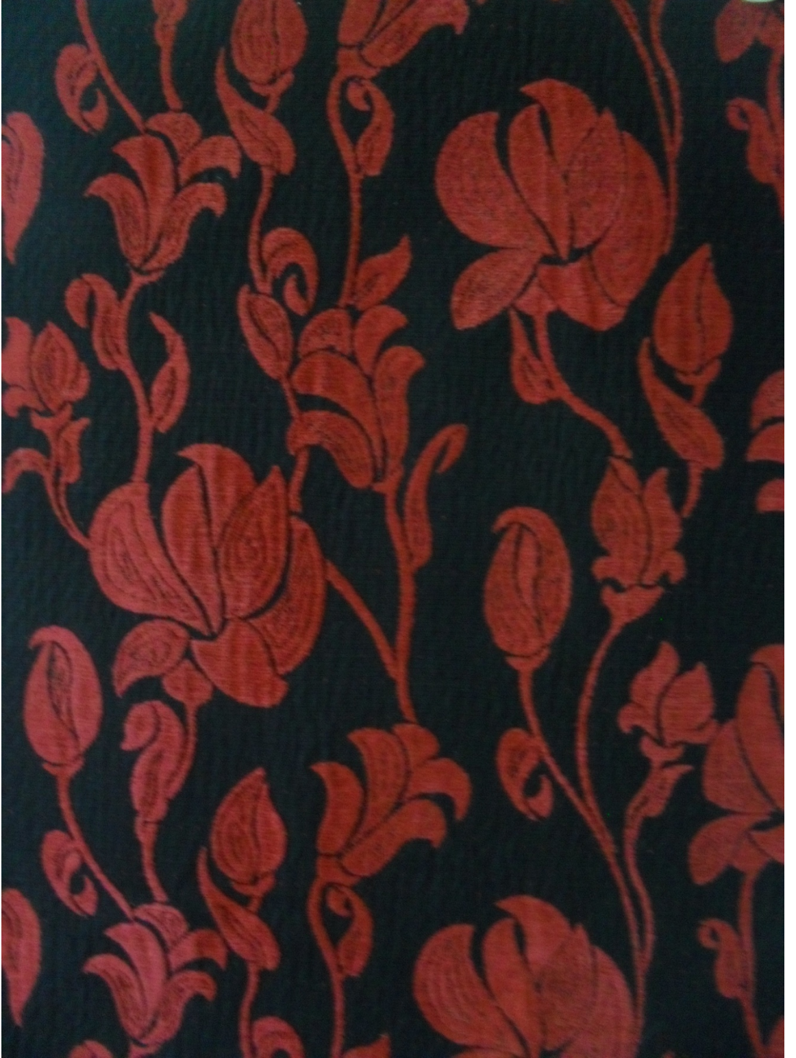
Şekil 9.58.: Atkıdan İşlemeli, Desen Şönil İplik, Zemin Akrilik ve Pes İplik, Torba Örgü Tekniğiyle Dokunan 6-A Numaralı Şönil Kumaş Detayı
