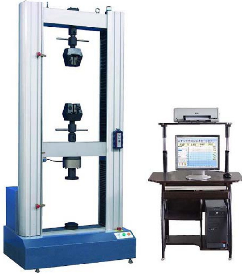
Şekil 9.2.: Kumaş Kopma Mukavemet cihazı
