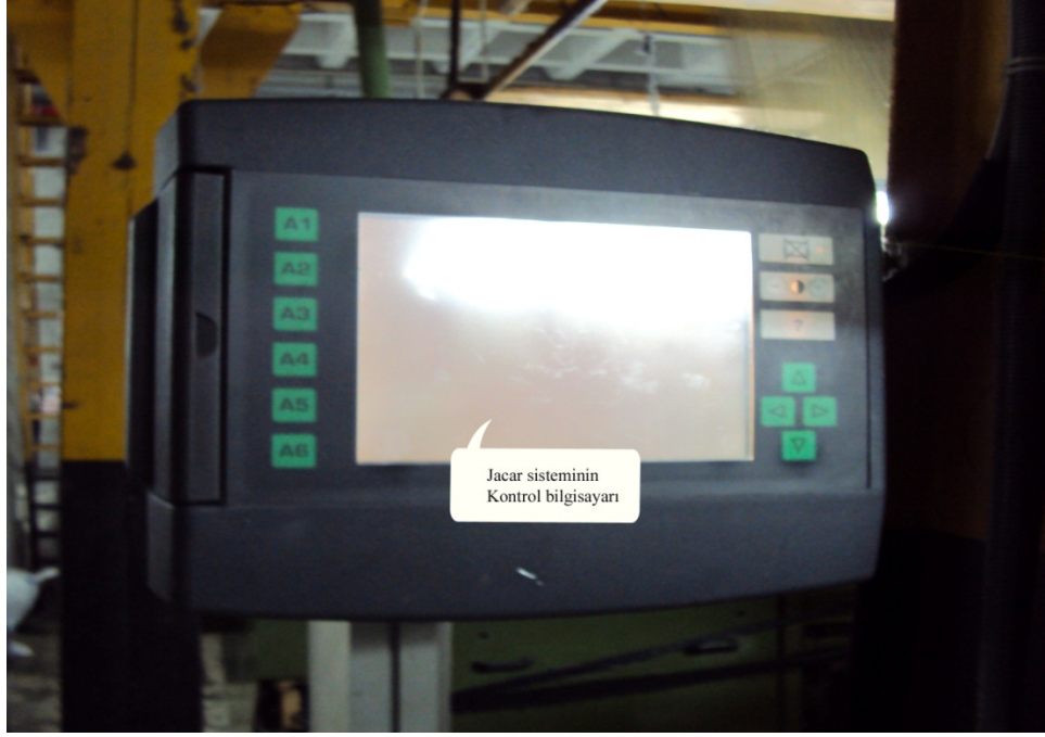
Şekil 3.19.: Kadife Tekstil Firmasında, Jakar Kontrol Cihazı
