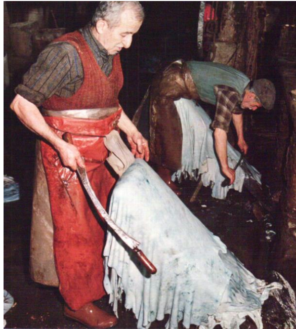
Şekil 4. 4. Deri üzerindeki maddelerin bıçakla temizlenmesi. Kaynak: Melda ÖZDEMİR, Nuran KAYABAŞI, 2007, s 77.
