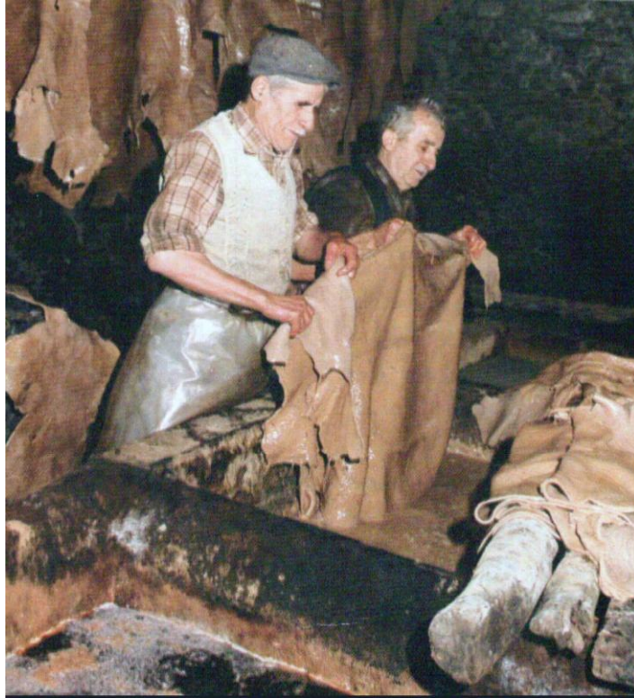
Şekil 4. 3. Kimyasal işlemden geçirilen derilerin sudan çıkarılması. Kaynak: Melda ÖZDEMİR, Nuran KAYABAŞI, 2007, s 74.
