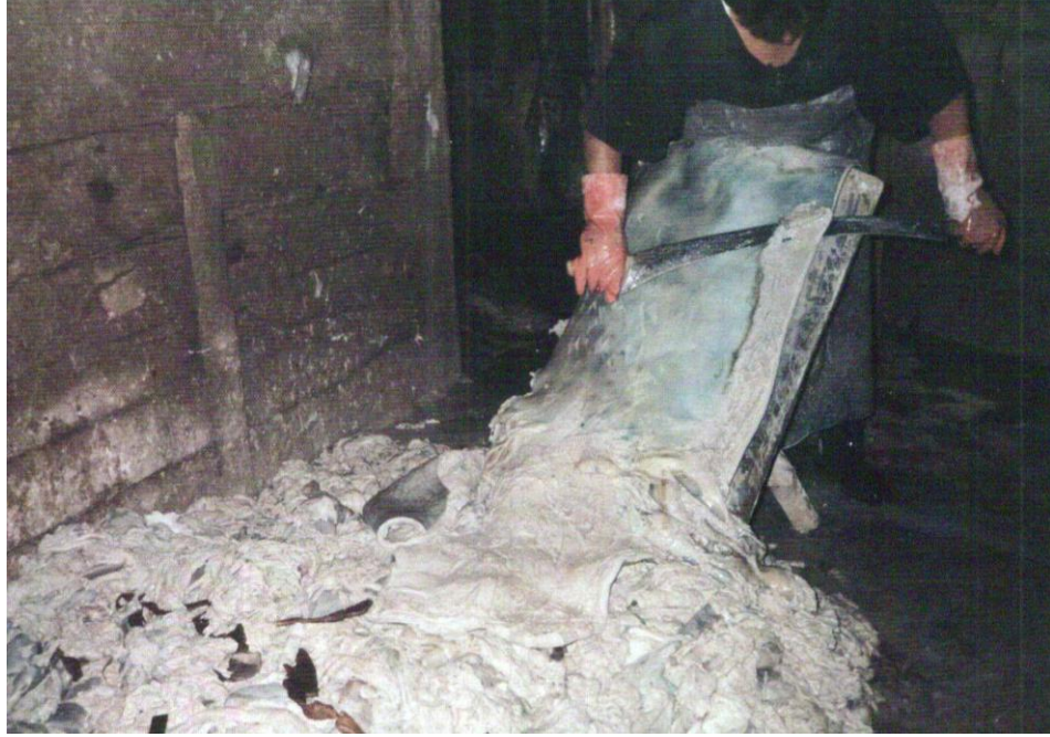
Şekil 4.5. Derinin kıl kökleri ve üst tabakasının giderilmesi.
