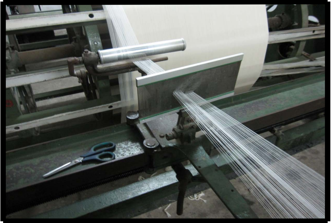
Şekil 3.21.: Çözü Hazırlama İşlemi.
