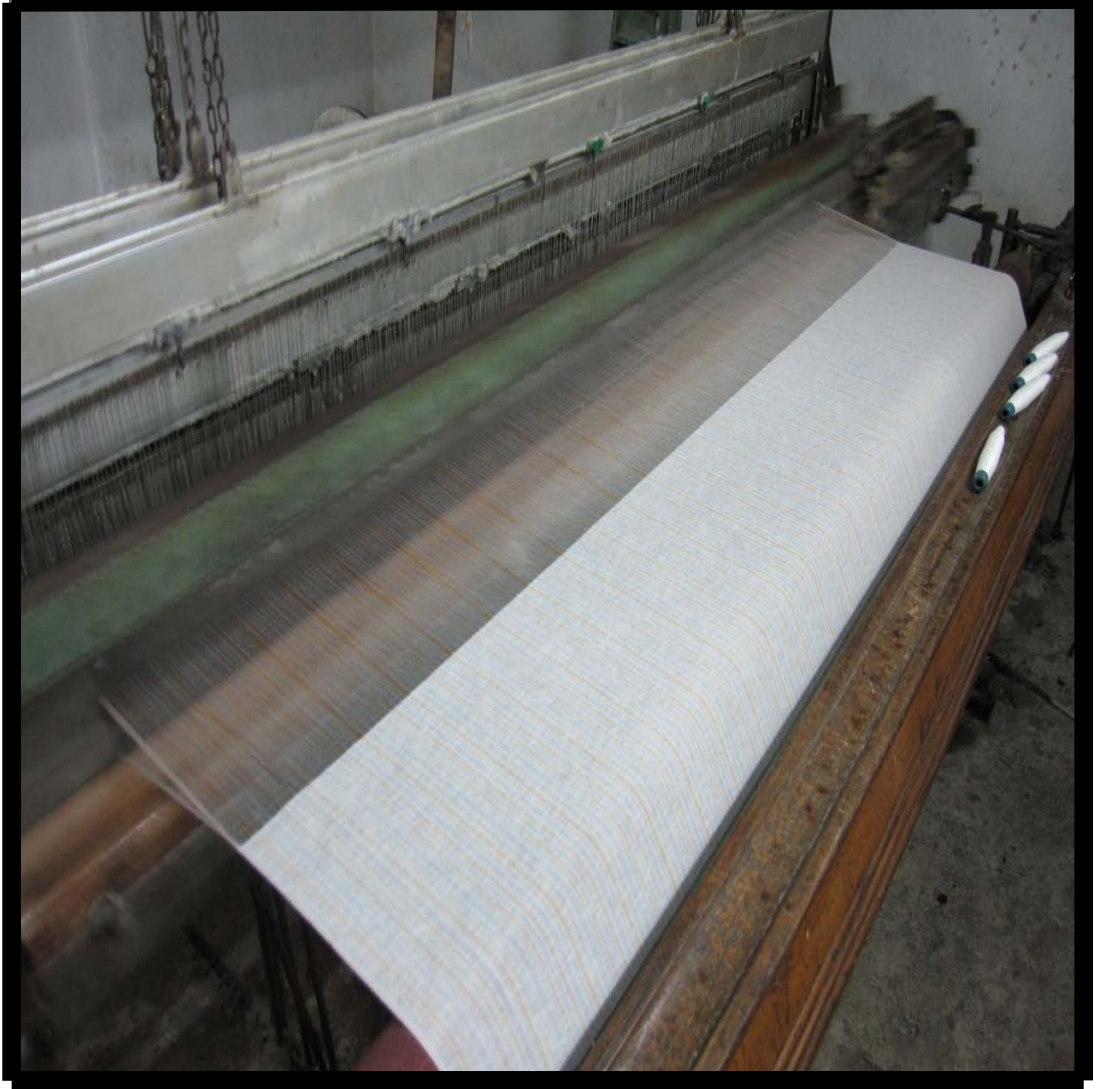
Şekil 3.22.: Mekanik Dokuma Tezgahında Dokunan Rize Bezi.
