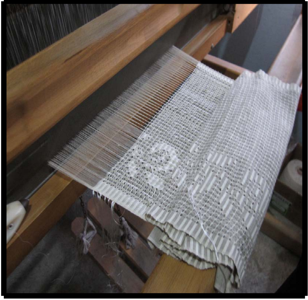
Şekil 3.4.: Dokunmakta Olan Rize Bezi Örneği.
